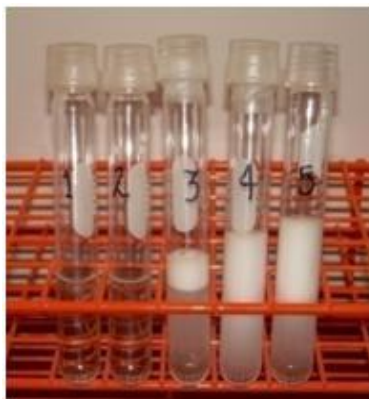
Figura 16. Tubos de ensaye conteniendo la solución AOT – Etilenglicol a diferentes concentraciones de AOT después de haber sido agitados 30 segundos en el minivortexer.
