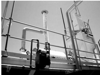
Figura 20. Horno regenerador de carbón activado
