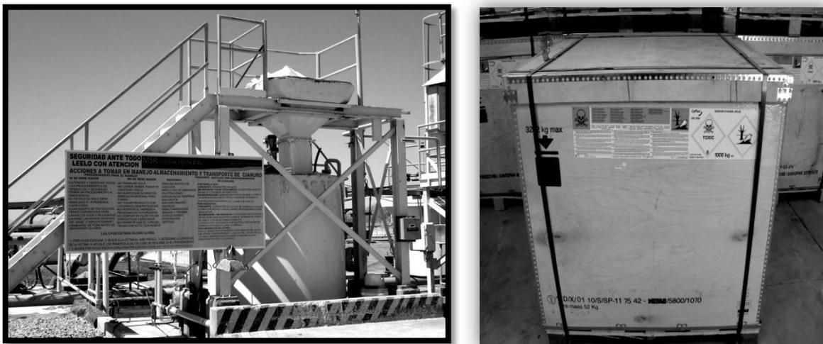
Figura 6. Tanque de preparación y depósito de almacenamiento de cianuro de sodio
