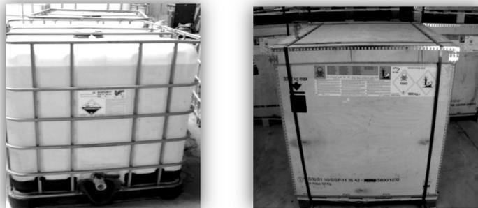
Figura 16. Depósitos de almacenamiento de los principales reactivos
