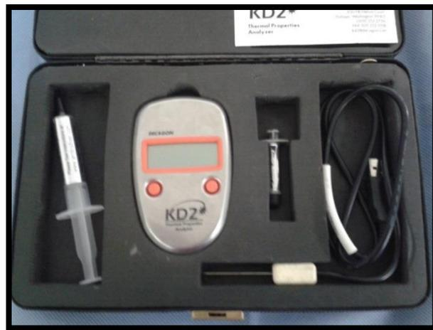
Figura 3.4 Elementos del Dispositivo KD2
