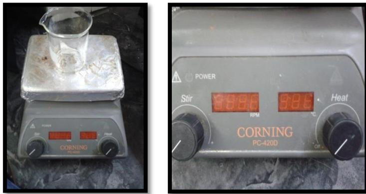
Figura 3.8 AM1 Agitador magnético Corning PC-4200.
