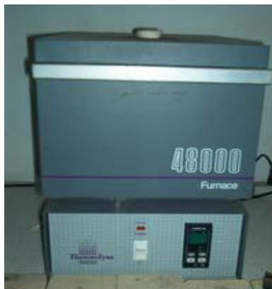
**Figura 3.** Imagen del horno empleado el procedimiento del secado de la mezcla de precursores.
