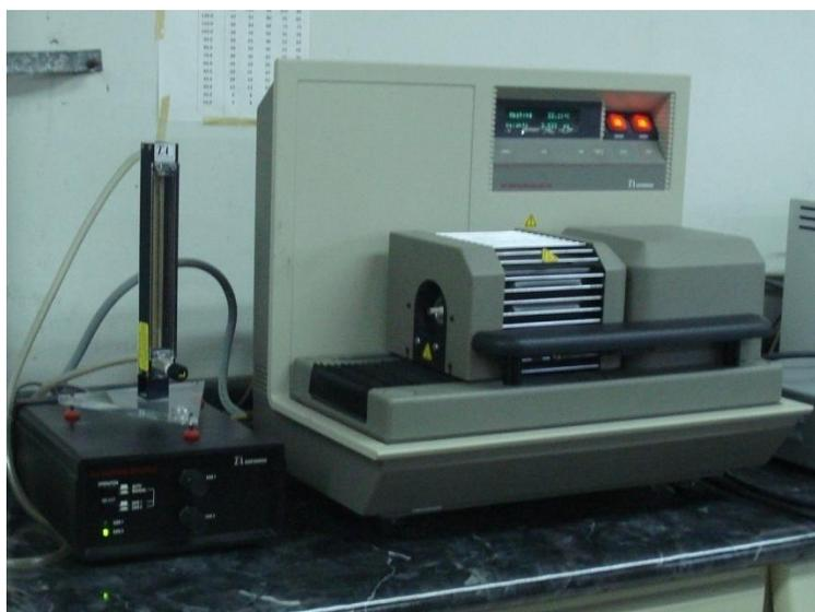
**Figura 6.** Analizador Simultaneo DSC-TGA.
