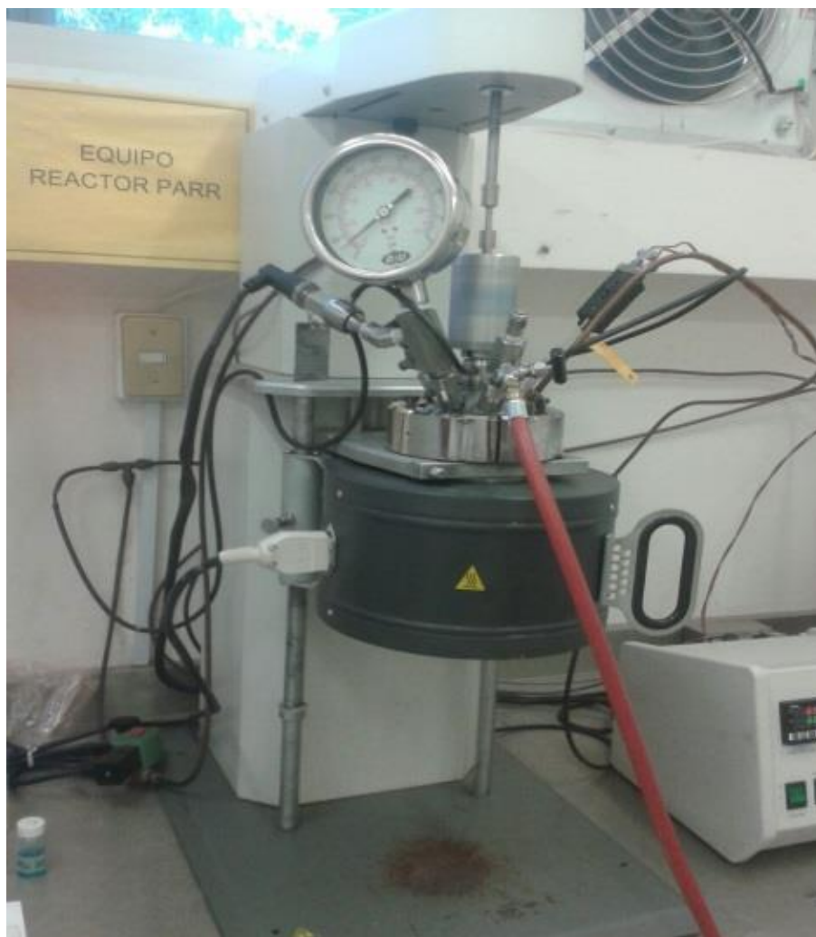
Figura 6. Reactor de Acero Inoxidable marca Parr.
