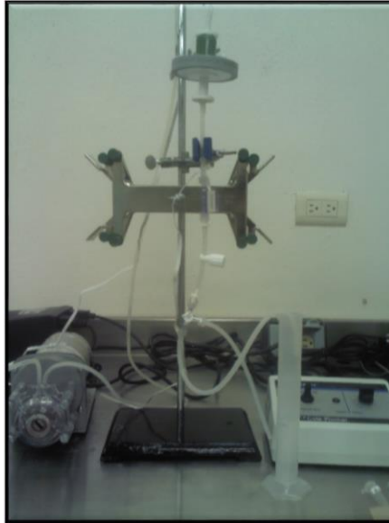
Fig. 13 Sistema de Microfiltración a Lecho Profundo, Bomba peristáltica (izquierda), soporte universal con microfiltro cápsula (centro), probeta para filtrado y controlador de velocidad (derecha).
