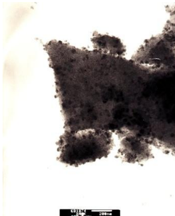
Figura 28. Micrografía de MET donde se aprecia la distribución de nanopartículas de oro embebidas en la matriz vítrea, \text{SiO}_2 .
