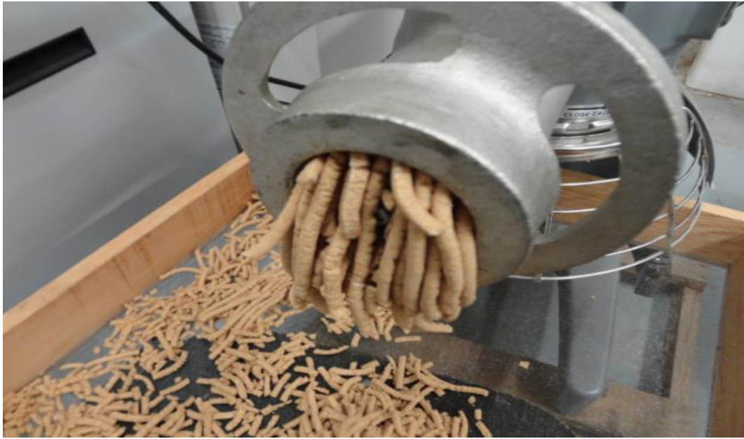
Figura 4. Elaboración de las dietas experimentales con un extrusor Hobart.
