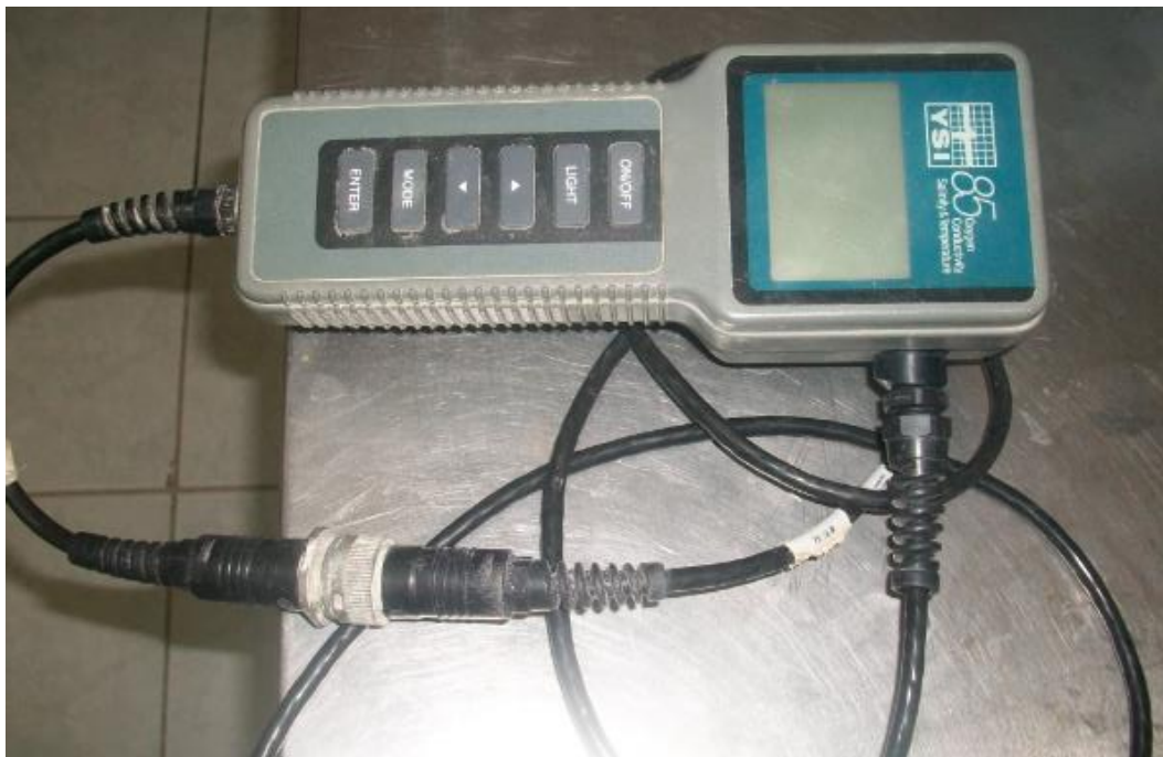
Figura 8. Oxímetro multi-función utilizado para la medición de temperatura, oxígeno disuelto y salinidad del agua de cultivo.
