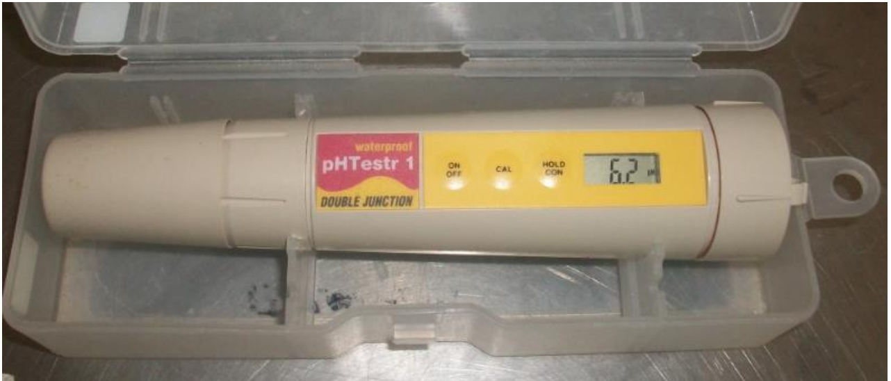
Figura 9. Potenciómetro utilizado para la medición de pH.
