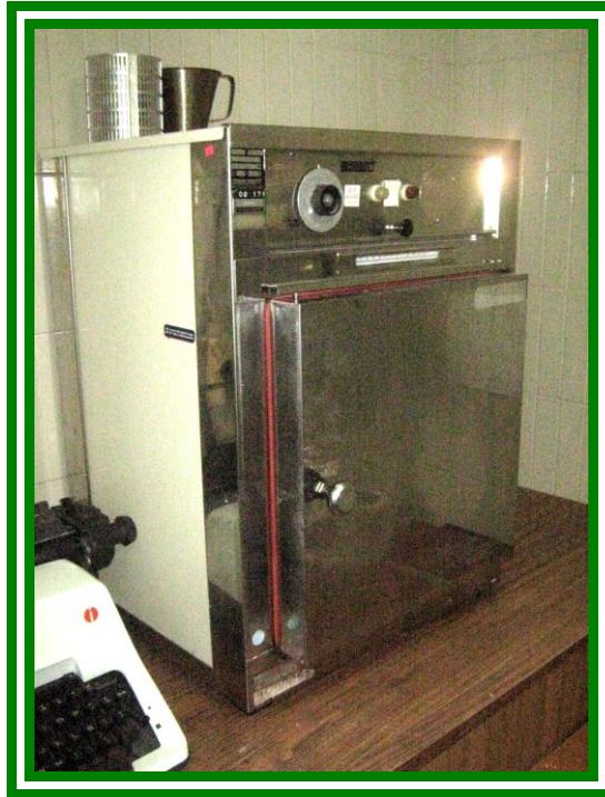
Figura 8.- Horno. Utilizado para la desparafinización de la muestra biológica durante la preparación de los cortes histológicos.
