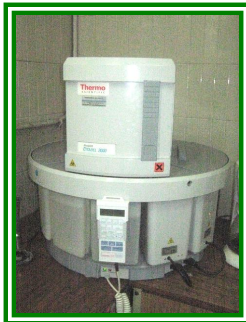
Figura 4.- Deshidratador. Utilizado en el proceso de inclusión de las muestras biológicas durante la preparación de los cortes histológicos.
