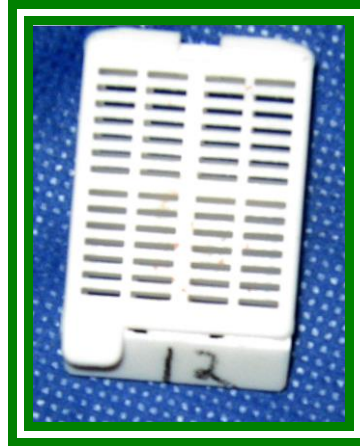
Figura 3.- Unicaset. Utilizado para la contención de las muestras biológicas (riñones) en formol durante la etapa de fijación en la preparación de los cortes histológicos.
