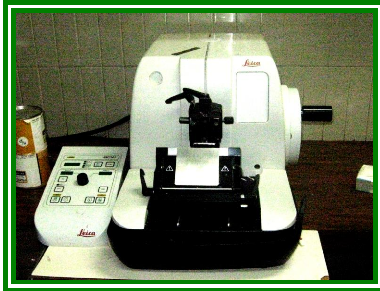
Figura 6.- Microtomo semiautomático. Utilizado para la realización de los cortes histológicos.
