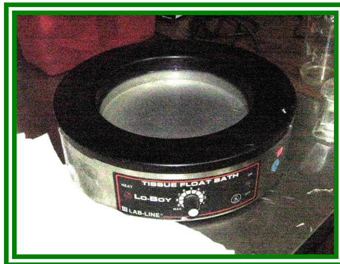
Figura 7.- Baño María. Utilizado para la extensión y adhesión de la muestra biológica durante la preparación de los cortes histológicos.
