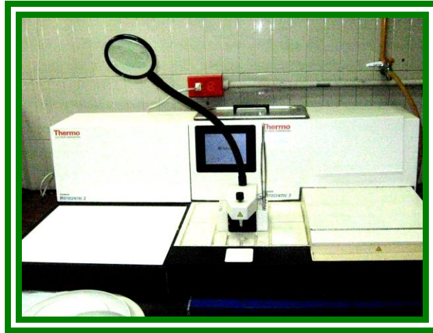
Figura 5.- Centro de inclusión con parafina. Utilizado para la realización de los bloques de parafina con las muestras biológicas.
