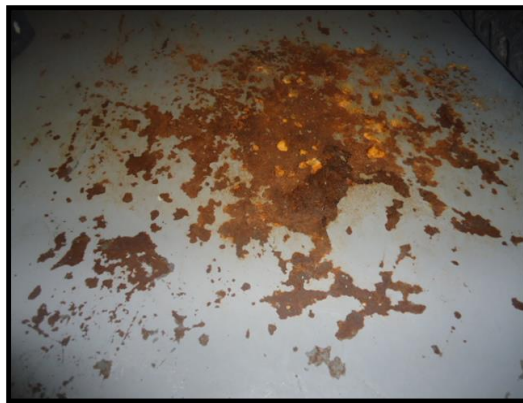
Figura 19: Daño Presentado por oxido en la Parte Inferior de la Mesa.
