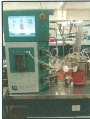
Figura 12. a) Biorreactor Applikon® (Holanda) de 2L acoplado al software ez-Control, b) Centrifuga Thermo Fisher Scientific®, ambos ubicados en el Laboratorio de Bioprosesos en el DICTUS.
