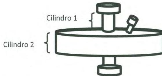
Figura 20. Cápsula de microfiltro utilizada en la experimentación
