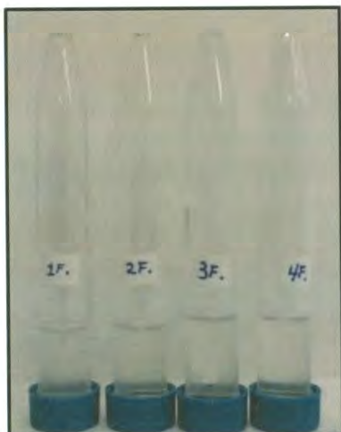
Figura 29. Muestras colectadas durante el proceso de microfiltración de lecho profundo con tamaño de poro de 4 \mu\text{m} y flujo de 6 \text{cm}^3/\text{min} a diferentes tiempos.
