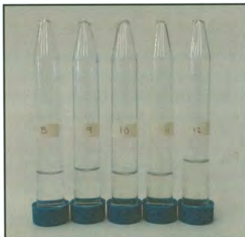
Figura 39. Muestras recolectadas durante el proceso de microfiltración de lecho profundo con tamaño de poro de 8\ \mu\text{m} y flujo 6\ \text{cm}^3/\text{min}
