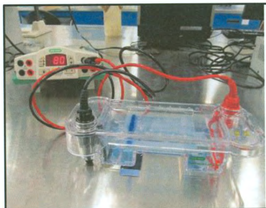
Figura 15. Cámara horizontal de electroforesis y Equipo Multi -Doc, Digital Imaging System, Trans UV de BioRad para fotografía.
