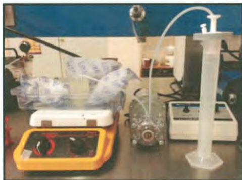
Figura 19. Sistema utilizado para el proceso de microfiltración de lecho profundo.
