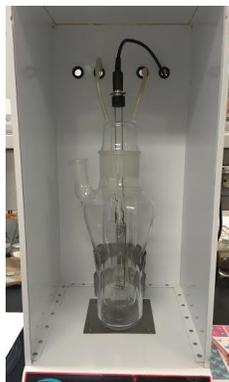
*Figura III.3. Reactor para realizar la degradación de colorantes.*
