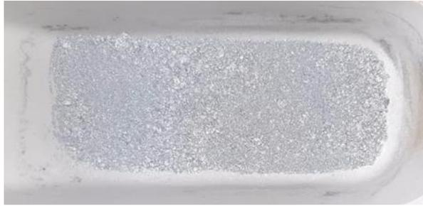
*Figura III.1. Dióxido de titanio soportado en cobre sin calcinación.*
