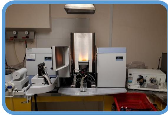
Figura 4. Equipo de Espectroscopia de Absorción Atómica
