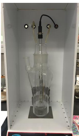
Figura III.2 Reactor para realizar la fotocatalisis de colorantes.
