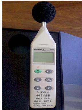
Figura 5. Sonómetro BK Precisión 732 A / 4132010418.
