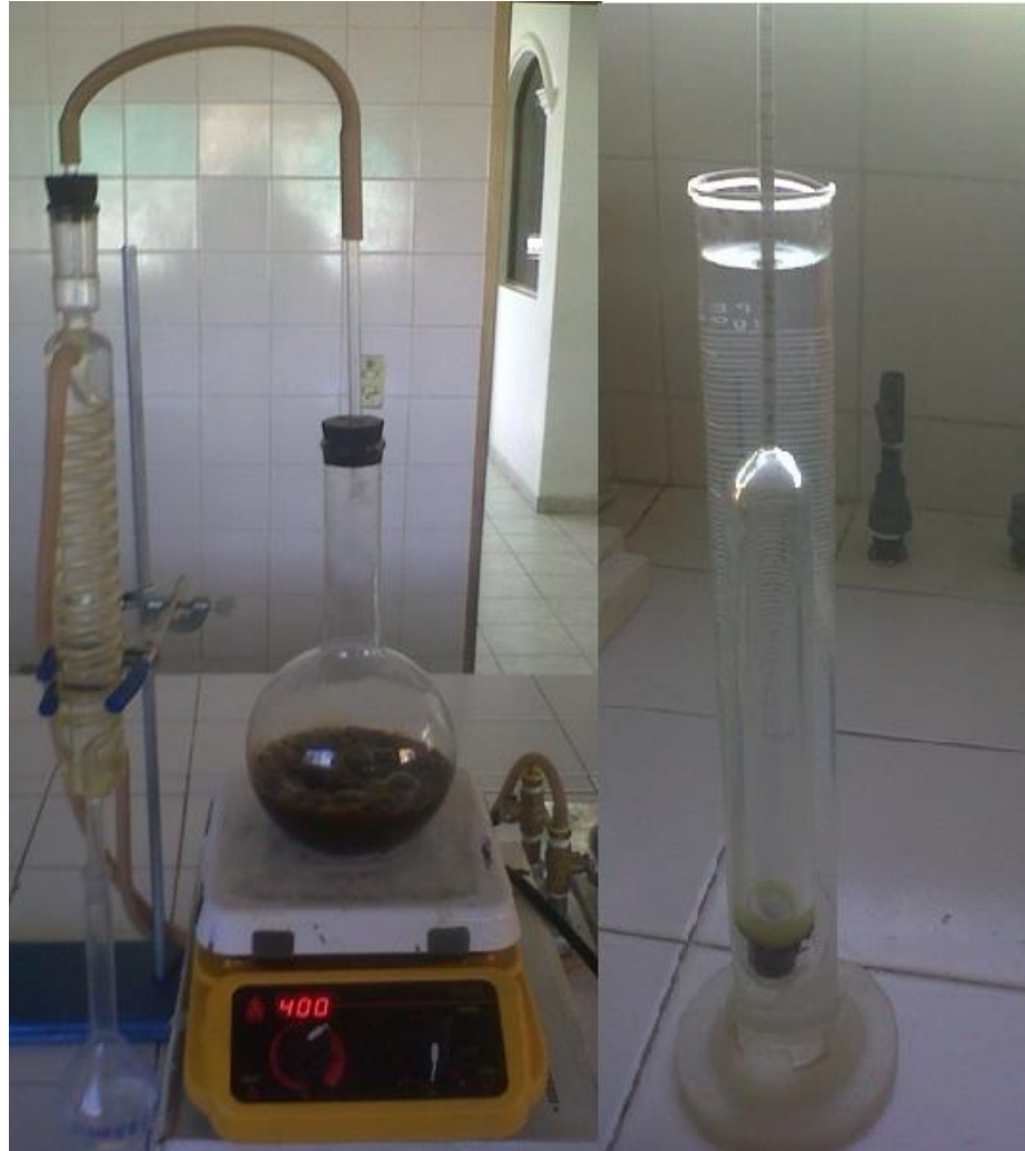
Figura 7. Destilación de melaza fermentada y obtención del °GL mediante densitometría.
