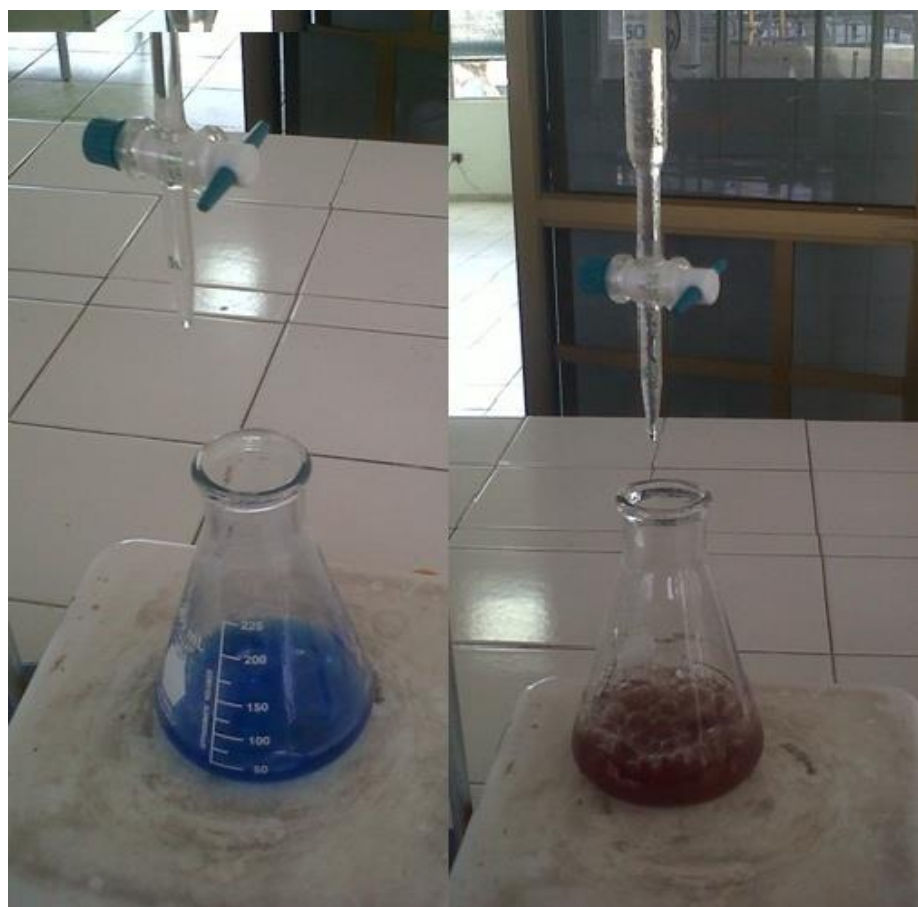
Figura 5 Cambio de coloración en la reacción redox llevada a cabo en la cuantificación de azúcares reductores y sólidos residuales reductores.
