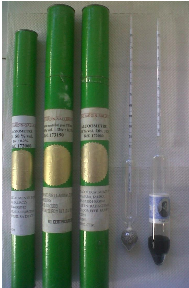
Figura 6. Alcoholímetros certificados Dujardin-Salleron con rango de 0-20°GL y 90-100°GL.
