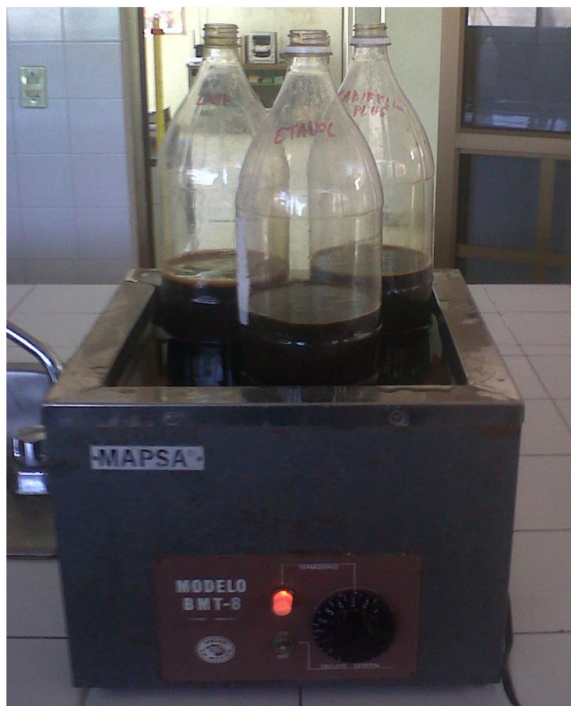
Figura 4. Control de la temperatura en las fermentaciones de melaza diluida a 25°B mediante baño maría eléctrico.
