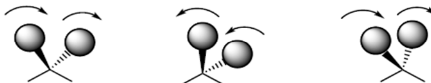
Vibración de flexión, cabeceo
