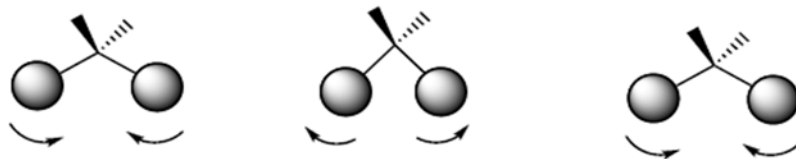
Vibración de flexión de tijera.
