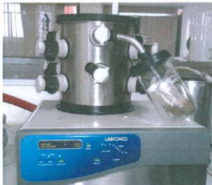
Figura 7. Liofilizador utilizado para secar biomasa.
