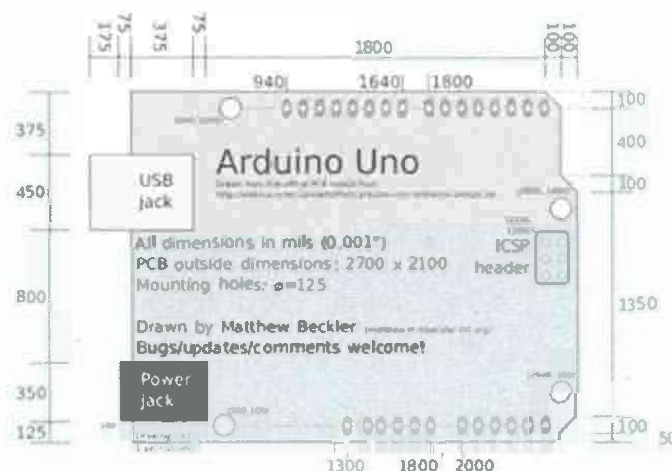
Figura 3.2 Dimensiones de la placa Arduino UNO
