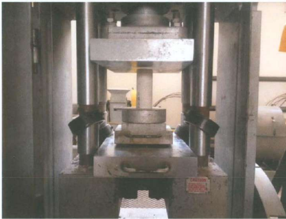
Figura 1. Prueba de Compresión Simple realizada con prensa hidráulica.
