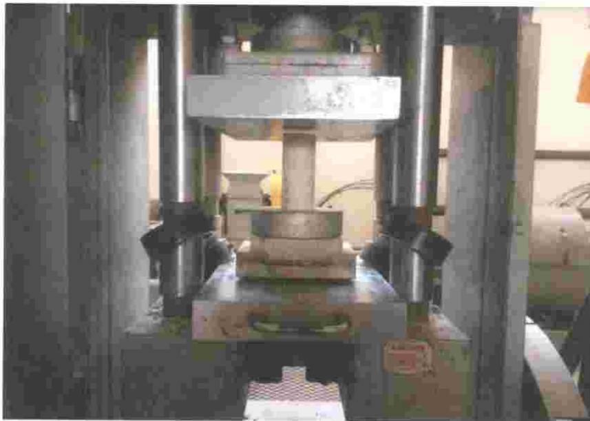
Figura 22. En la imagen se observa la muestra de compresión simple colocada en la prensa hidráulica antes de ser tronada.
