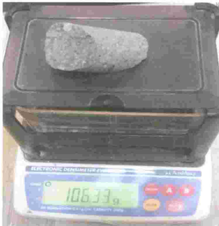
Figura 33. Se muestra el valor del peso de la muestra en seco.
