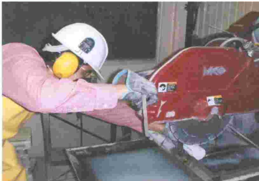
Figura 14. En la imagen se observa la realización del corte de la muestra.
