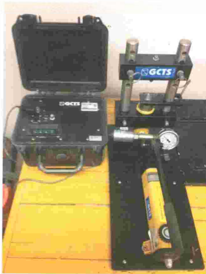
Figura 9. En la imagen se observa la Prensa franklin. En la cual se observa como está compuesta desde el cilindro de presión con la palanca, las puntas cónicas que generan una presión en la muestras, la caja electrónica receptora de la información del esfuerzo máximo en el barreno.
