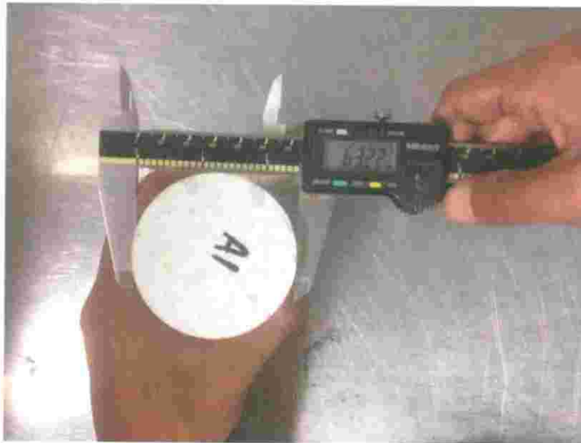
Figura 25. Se muestra midiendo el testigo, esta acción se realiza 3 veces para obtener un promedio.
