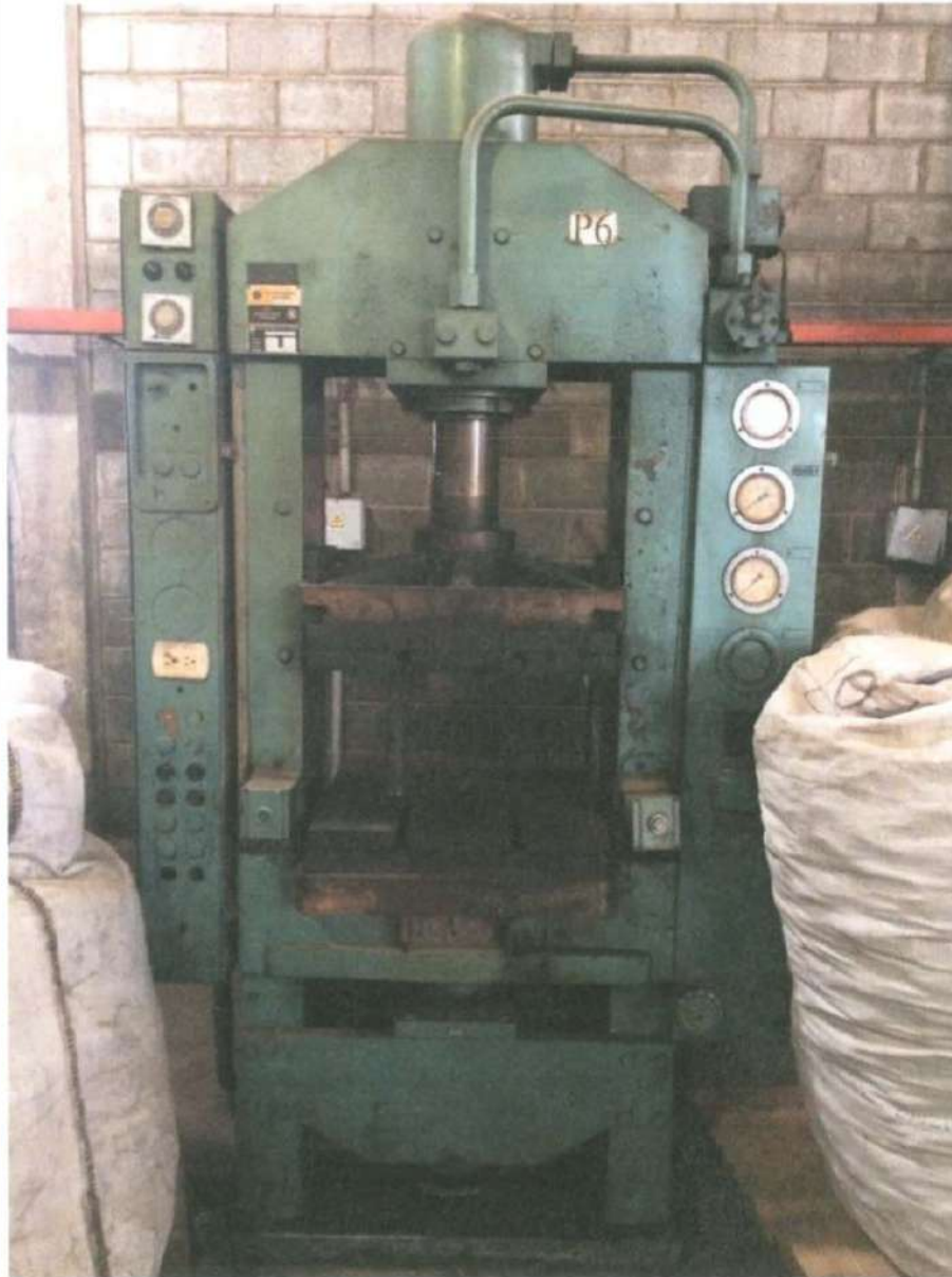
Figura 21. En la imagen se observa la máquina utilizada para medir la resistencia a la compresión simple de las pruebas.
