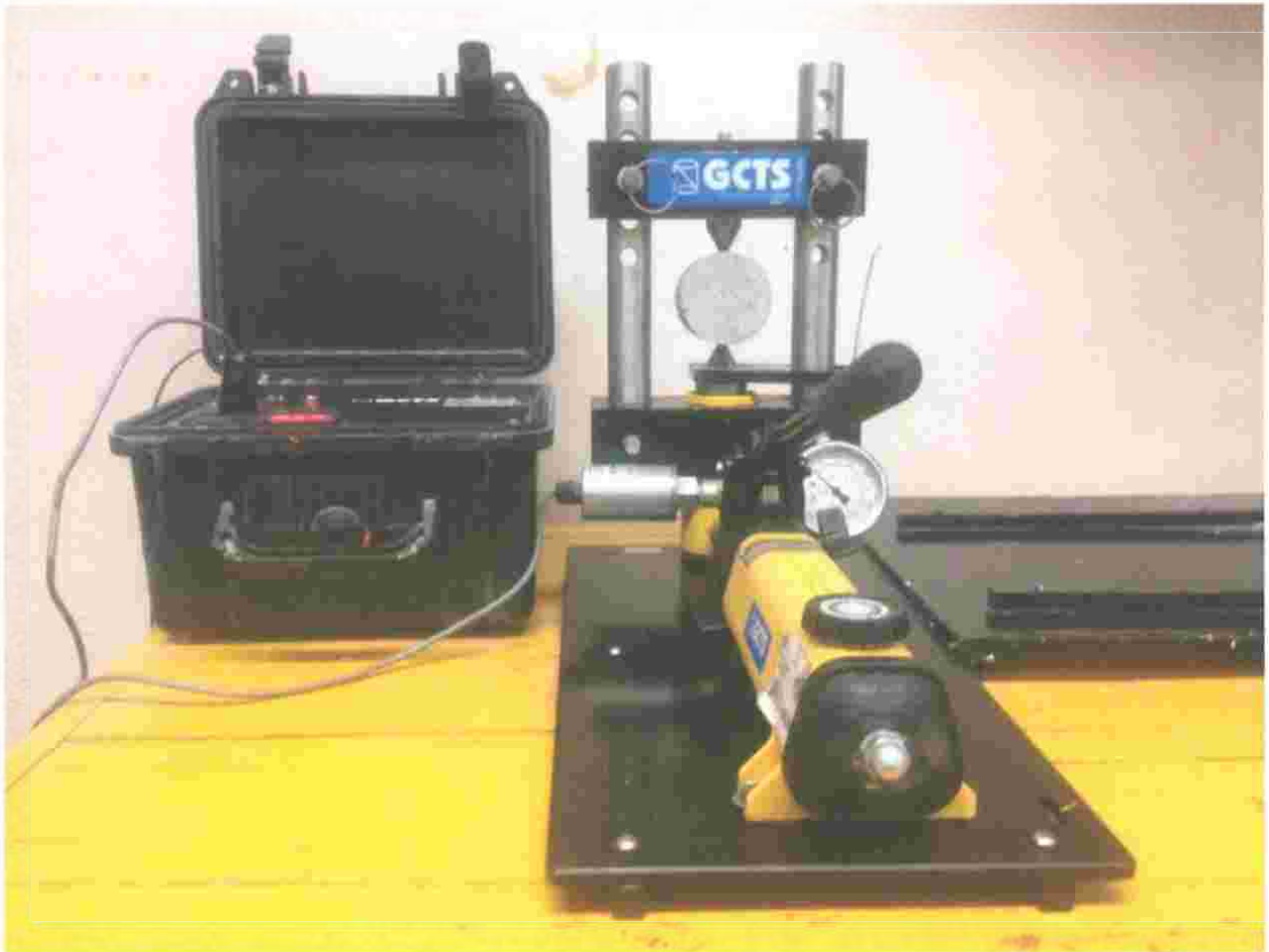
Figura 24. El cilindro hidráulico es accionado mediante una bomba hidráulica manual a través del cual se aplica la carga de compresión sobre la muestra.
