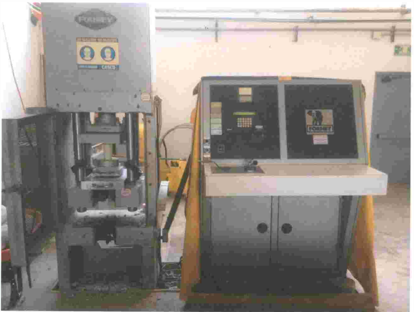
Figura 8. En la imagen se observa como está compuesta la prensa hidráulica el cual cuenta con la parte de tronado y con la cabeza de información electrónica.
