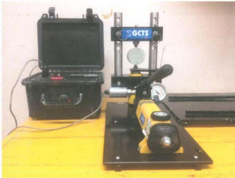
Figura 2. Prueba de Carga Puntual realizada con Prensa Franklin.
