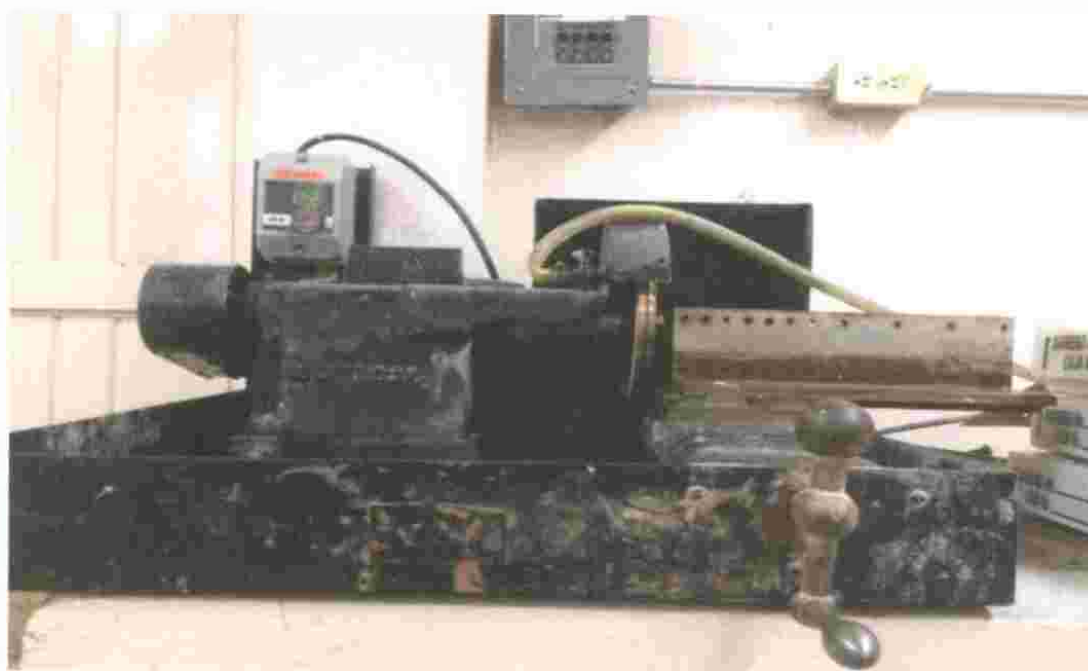
Figura 7. El esmeril es de suma importancia para algunas pruebas para el pulido de los extremos.
