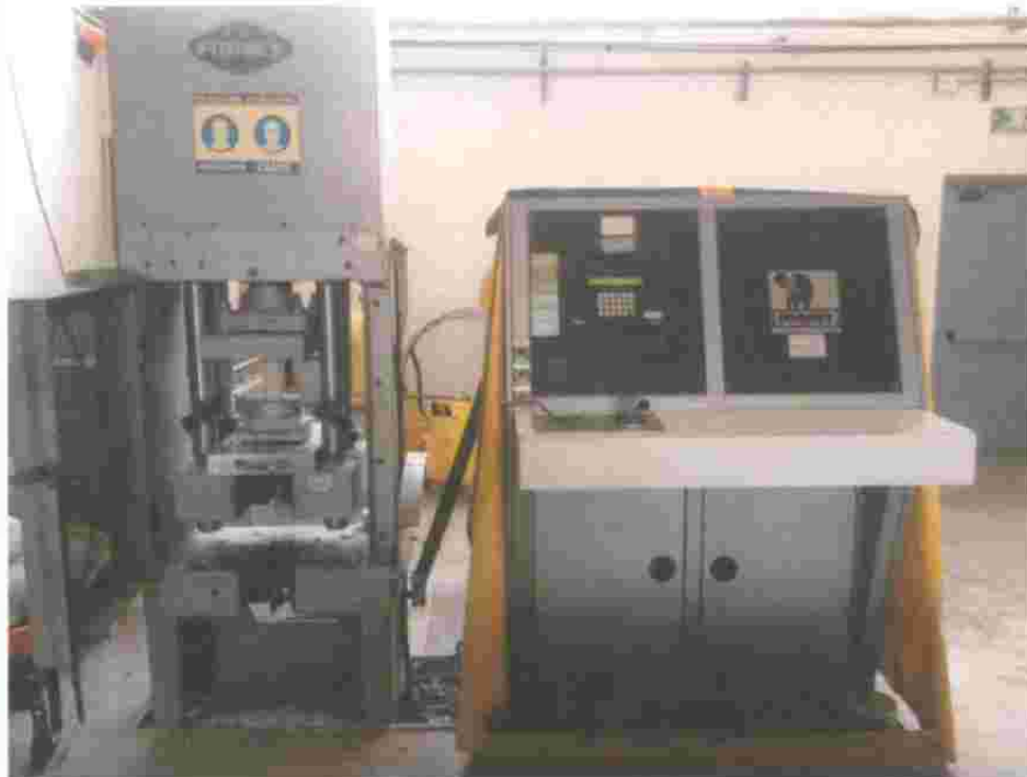
Figura 16. Este es el equipo utilizado para tronar los barrenos para la prueba de Compresión Simple.
