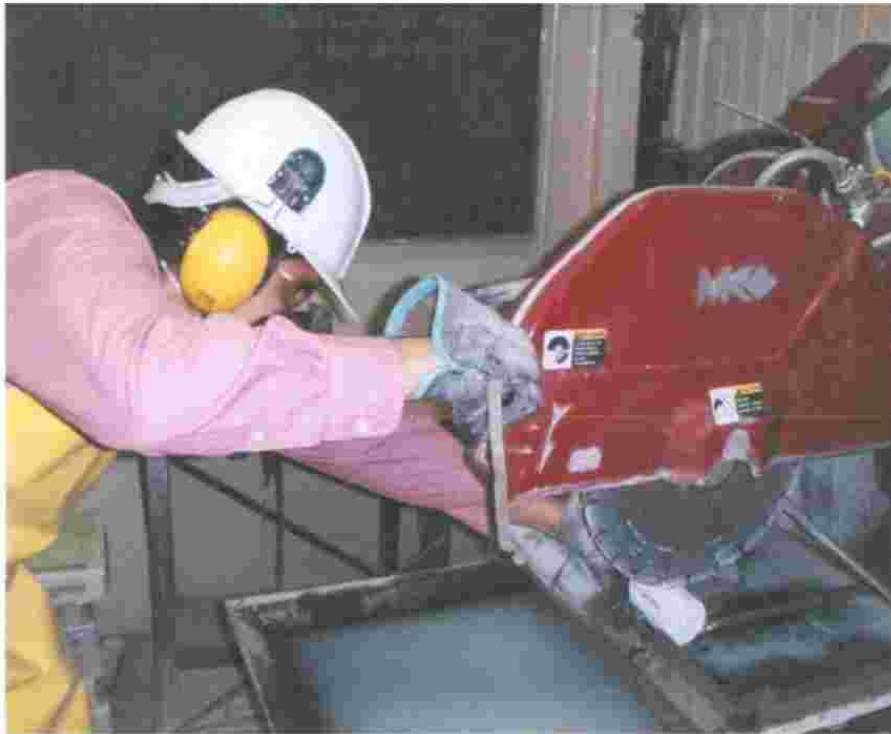
Figura 27. Se observa cómo se procede a cortar el testigo.
