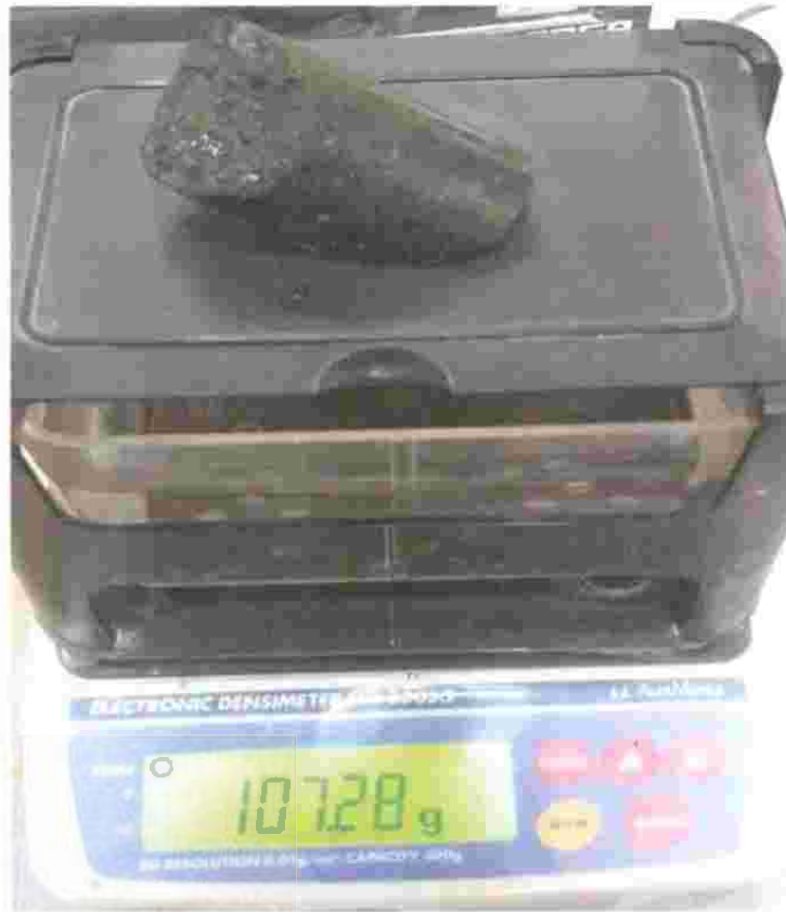
Figura 35. La muestra se retira del baño de inmersión y se obtiene el peso saturado.
