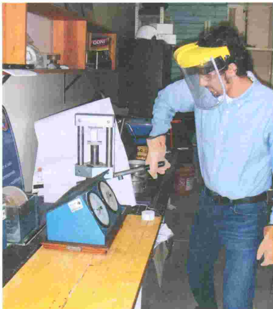
Figura 29. Se observa cómo se aplica la carga a la prensa, al igual que se debe de contar con todo el equipo de protección personal.
