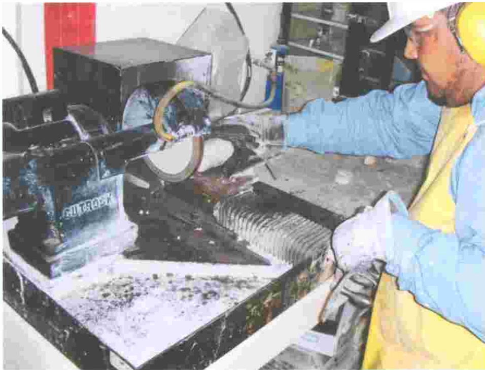
Figura 15. En la Imagen se observa la máquina de pulido (esmeril), con esta máquina se pulen los extremos de la muestra ya sea en forma cilíndrica o cuadrada.
