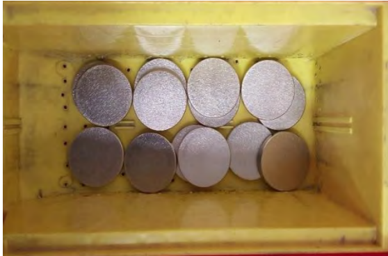
Figura 19. Magnetos con residuo de polvo
