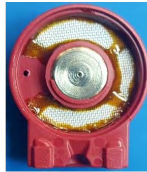
Figura 15. Micrófono con damping cloth y mezcla de adhesivo
