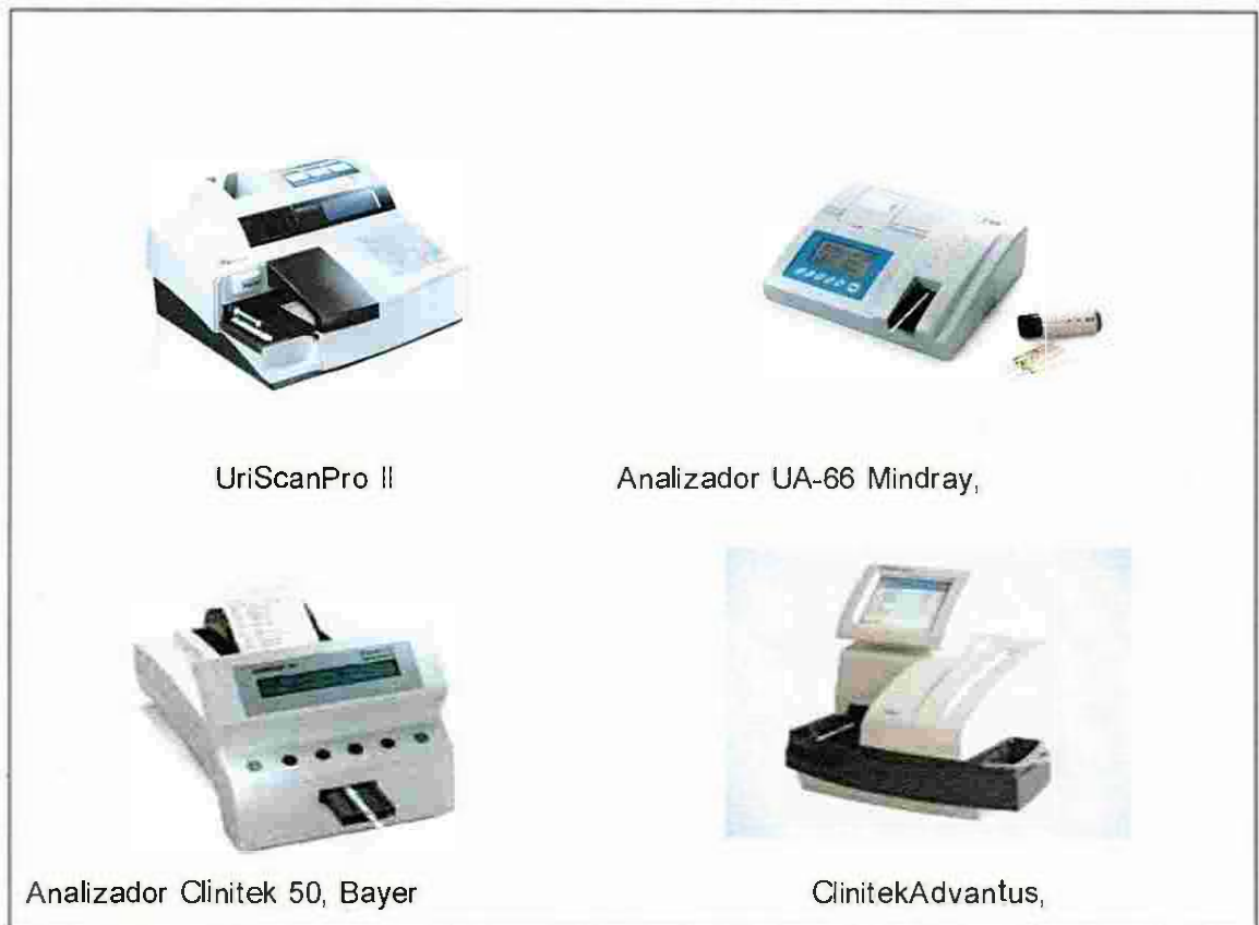
Figura 7. Analizadores semiautomáticos para análisis químico de la orina.
