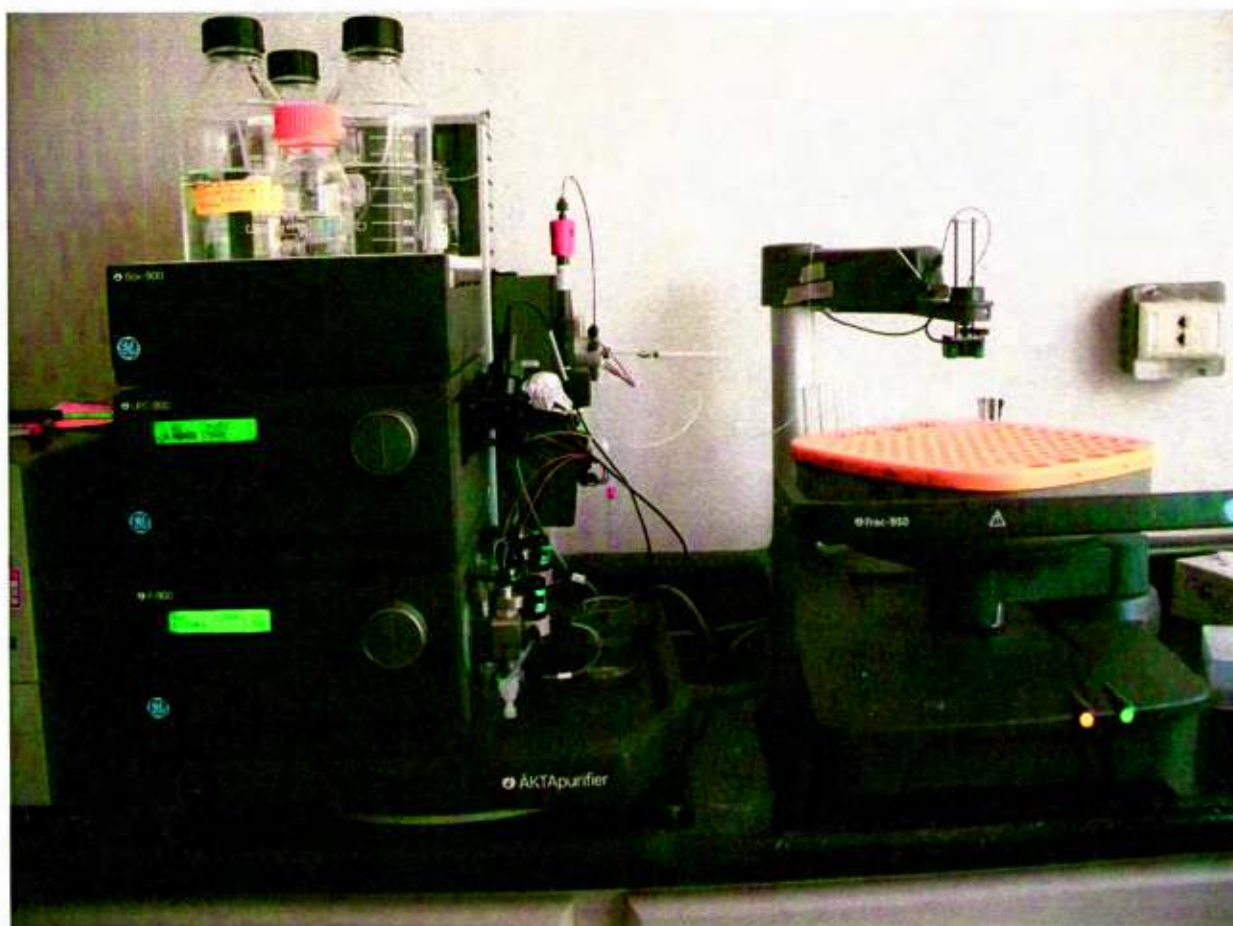
Figura 9. HPLC ÄktaPurifier de GE con la columna de Interacción Hidrofóbica instalada.
