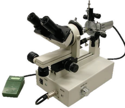
Figura 12. Microforja MF-900 de Narishige. Este instrumento sirve para hacer regulares las puntas de las micropipetas.
