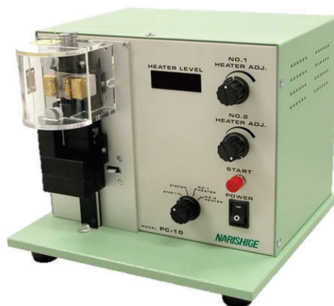
Figura 11. Estirador PC-10 de Narishige. Este aparato sirve para calentar y estirar los capilares de borosilicato, con lo cual se forman las micropipetas.
