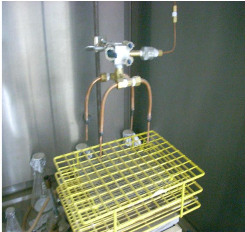
**Figura 5. Foto del sistema evaporador de nitrógeno con 4 salidas.**
