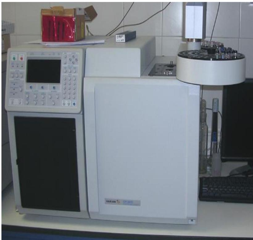
**Figura 7. Foto del cromatógrafo de gases (VARIAN cp-3800).**
