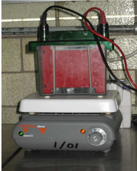
Figura 23. Electrotransferencia de extractos amibianos a membrana de NC.
