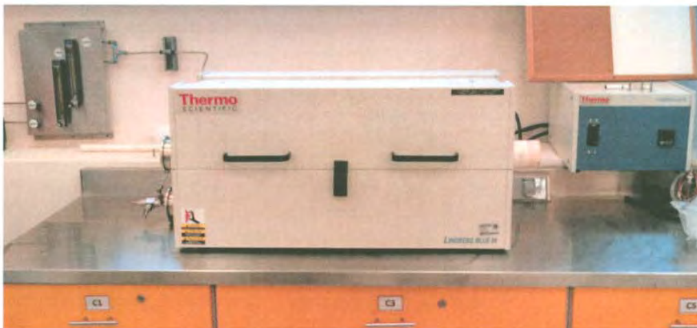
Figura 14. Imagen de Horno tubular donde se lleva a cabo la reducción magnesiocarbónica de sílice.
