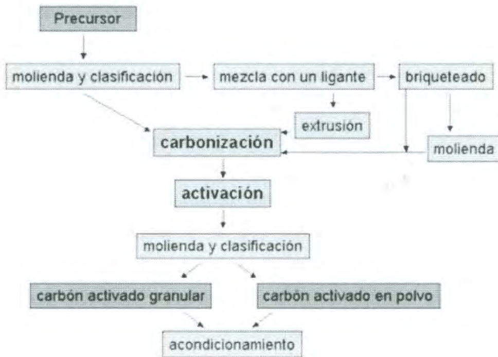
Figura 3. Diagrama de los distintos procesos que pueden tener lugar en la activación física.
