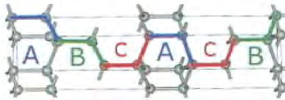
Figura1. Estructuras de los principales polítipos de SiC
