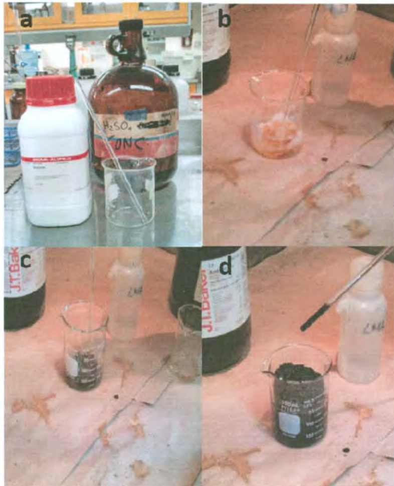
Figura 5. Imágenes a, b, c y d del proceso de la reacción de sacarosa con ácido sulfúrico para la formación de carbón.
