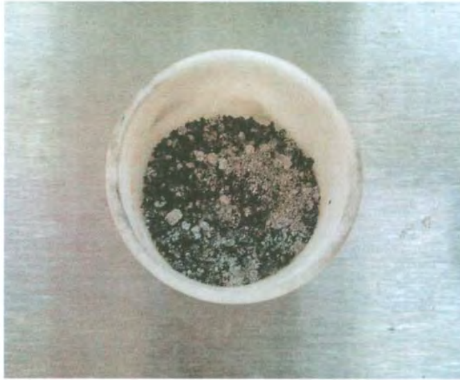
Figura 13. Imagen de la muestra del precursor C/SiO 2 /Mg en crisol de alta pureza.
