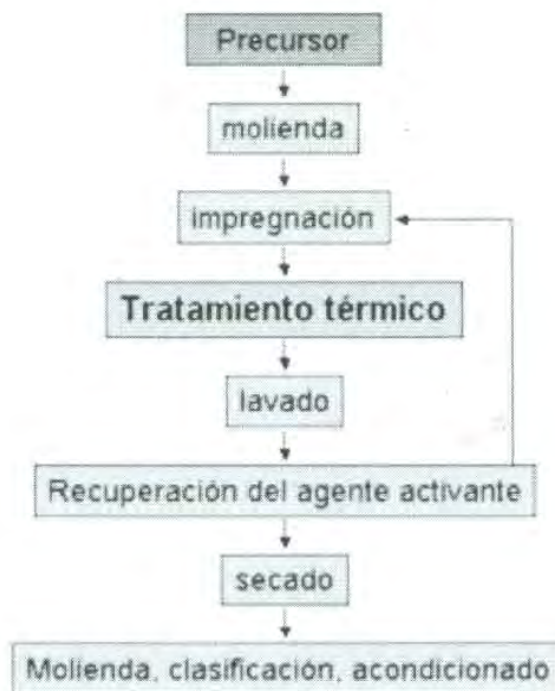
Figura 4. Diagrama de activación química.
