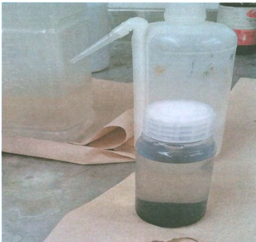
Figura 17. Imagen de neutralización de ácidos mediante hidróxido de sodio 0.1 M.
