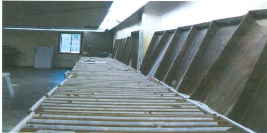
Figura 9. Identificar la dirección de fractura en la roca, vertical, horizontal y diagonal
