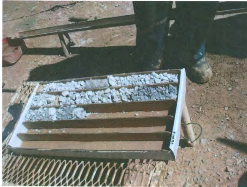
Figura 8. Perforación en falla, núcleo, fracturado con poca recuperación
