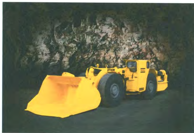
Figura 21. Camión de bajo perfil
