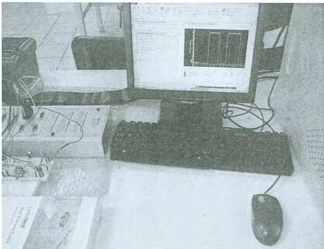
Figura 3.40 Monitoreo y análisis en ControlDesk de las variables del sistema de control.
