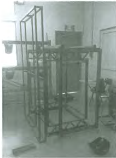
Figura 5.32 Soporte móvil de la placa caliente y la estructura que lo soporta
