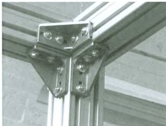
Figura 5.28 Juntas de los perfiles de aluminio con Gussets
