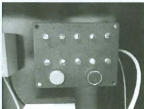
Figura 6.8 Modulo On(verde)/Off(negro) con indicadores de dispositivos en funcionamiento
