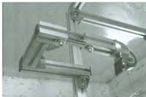
Figura 5.25 Sistema de amortiguamiento de apoyo
