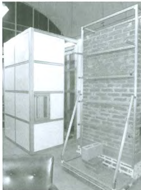
Figura 5.31 Vista externa del dispositivo y muestra en proceso de fabricación
