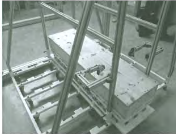
Figura 5.26 Base de madera, aislante de la muestra
