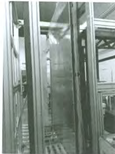
Figura 5.36 Placas fría y caliente frente a frente
