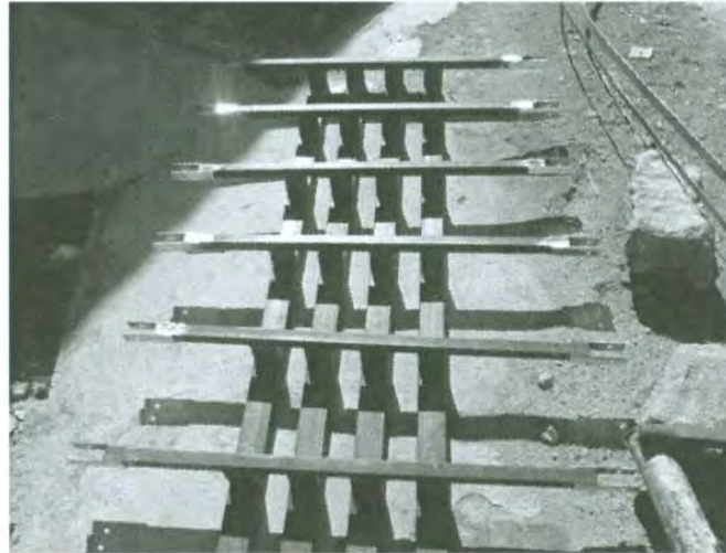
Figura 5.23 Porta muestras externo en proceso de fabricación
