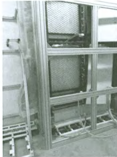
Figura 5.42 Distribución de placas frías y orden de los termopares
