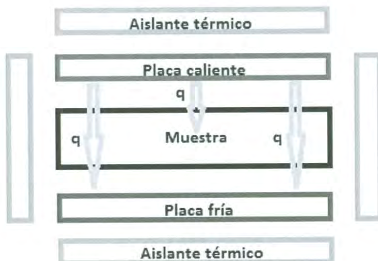
Figura 3.2 Esquema de flujo de calor en el sistema
