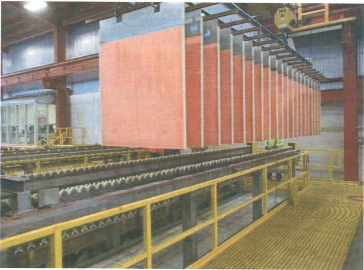
Figura 19. Placas de cobre con 99.97% de pureza (impurezas menores de plomo, fierro y azufre).
