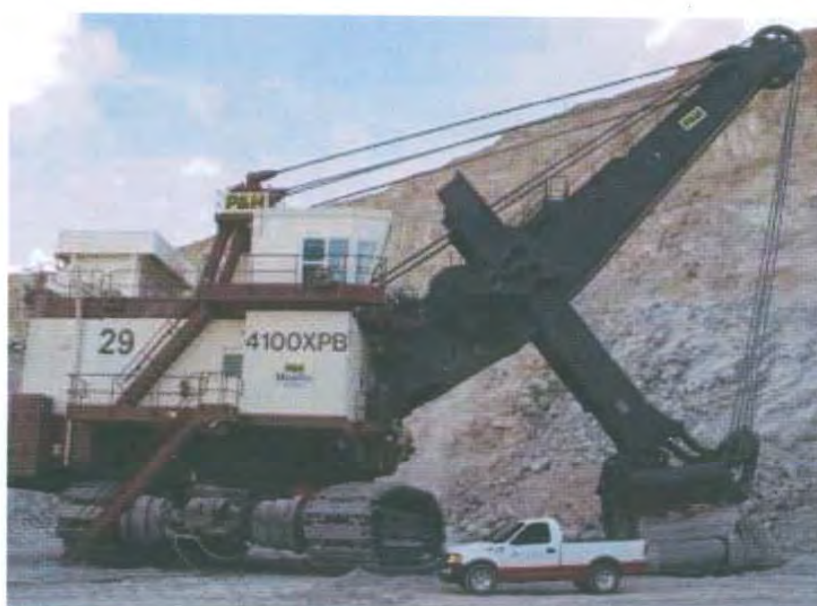
Figura 9. Pala P&H 4100XPB con capacidad de 137 yds. Cubicas.
