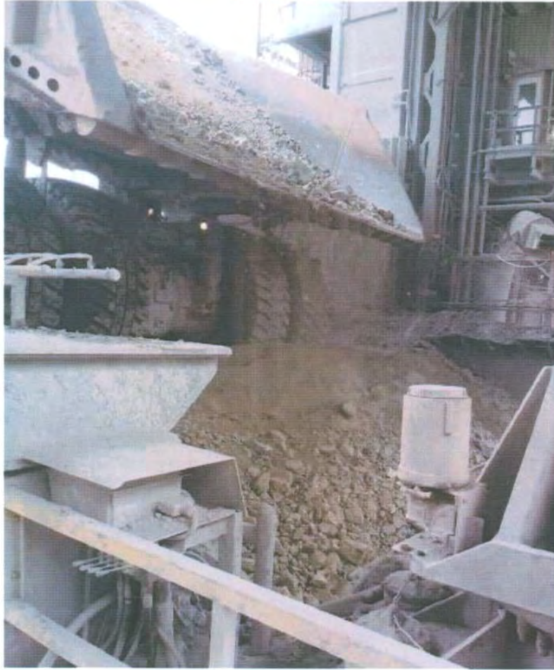
Figura 12. Descarga de mineral sobre quebradora primaria.
