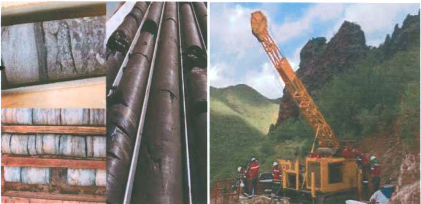
Figura 6. Barrenación a diamantes y muestras cilíndricas de un barreno.
