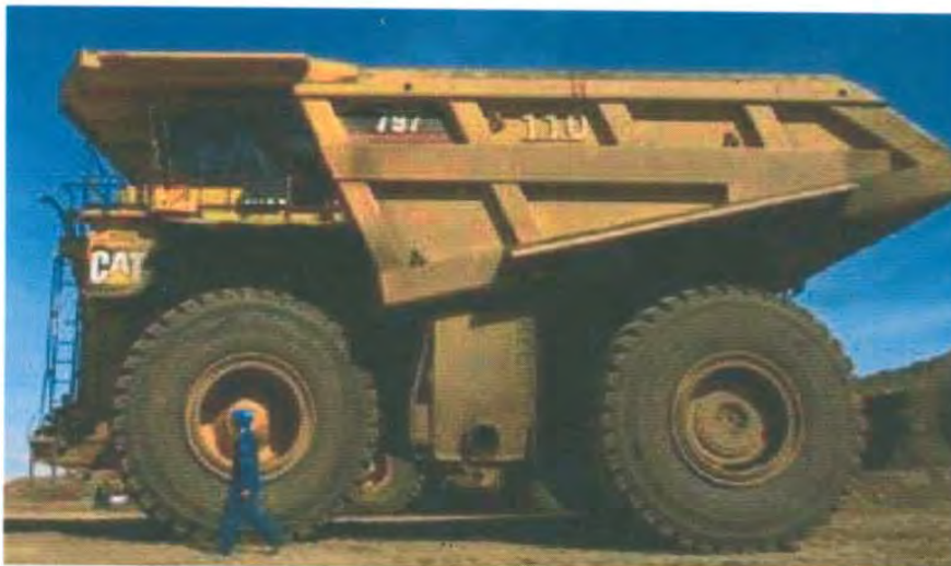
Figura 8. Camión 797F de Cartepillar con capacidad de 360 Tons.
