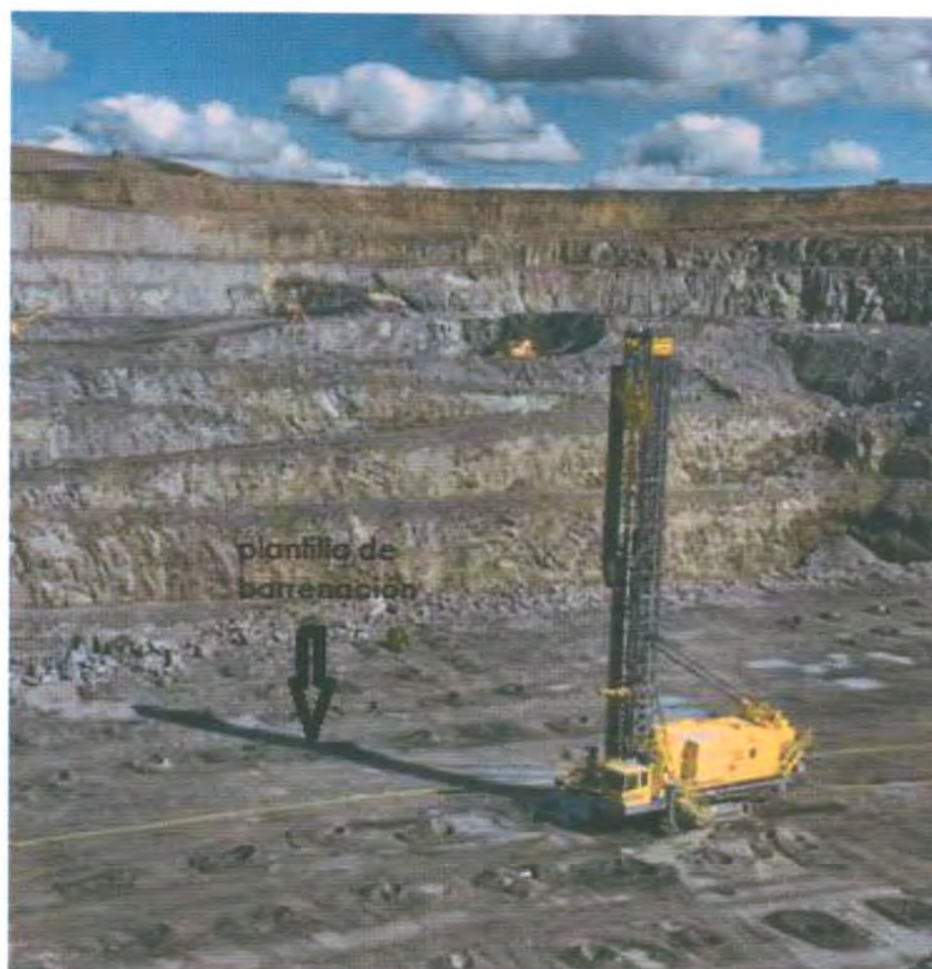
Figura 6. Perforadora Pit Viper 351 de atlas copco.
