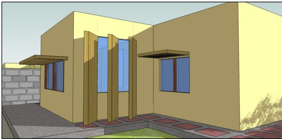
**Figura 61.** Detalle de alero y parasoles para protección de fachadas
