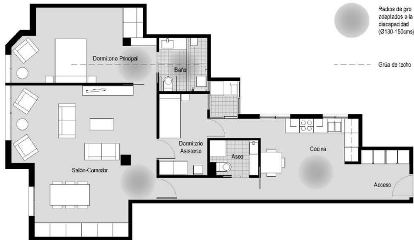
Imagen 2. Planta arquitectónica con radios de giro. C/E. Fuente: [www.reformadevivienda.com](http://www.reformadevivienda.com).
