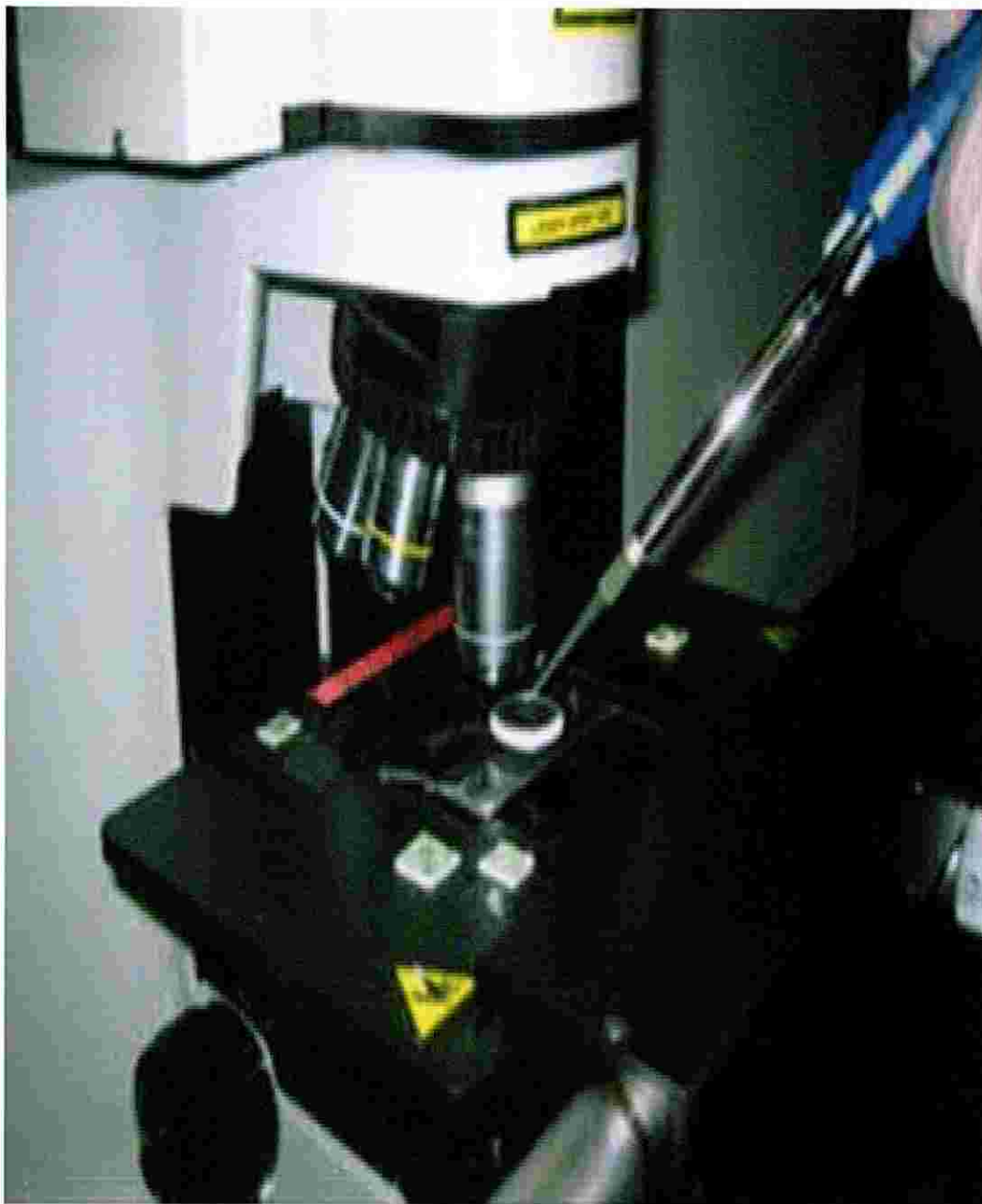
Figura 8. Equipo Raman para el estudio del cáncer de mama.
