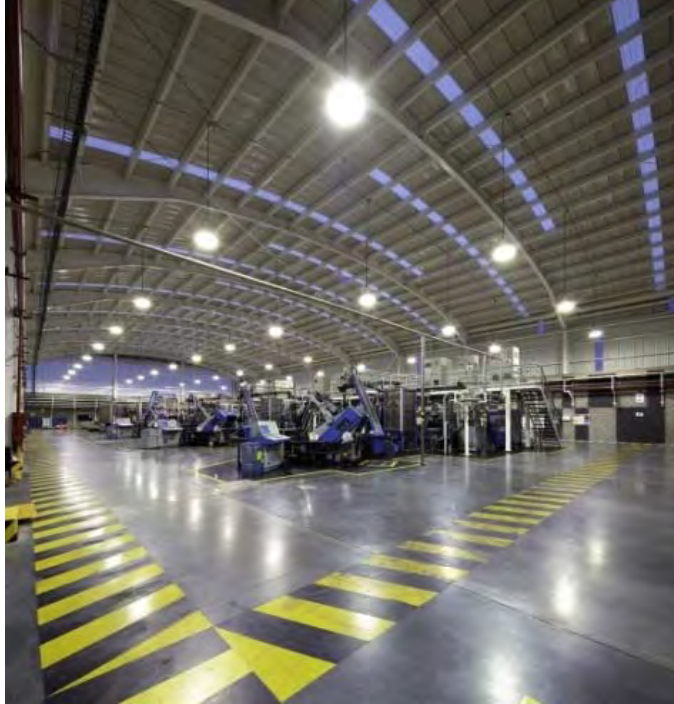
Ilustración 5: Área de producción de la cervecería. Se observa la amplitud de espacios, para el acomodo de maquinaria, concreto pulido en pisos, y amplias circulaciones alejados de las máquinas. (Fuente: http://www.archdaily.mx )
