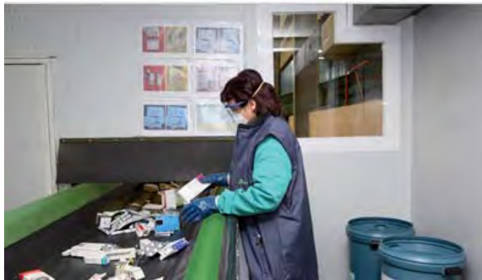
Ilustración 16: Trabajador separando materiales que pasan por la cinta de clasificación. (Fuente: www.kie.com.br )
