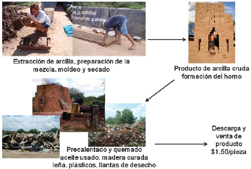
**Figura 4.** Procedimiento de elaboración del ladrillo.
