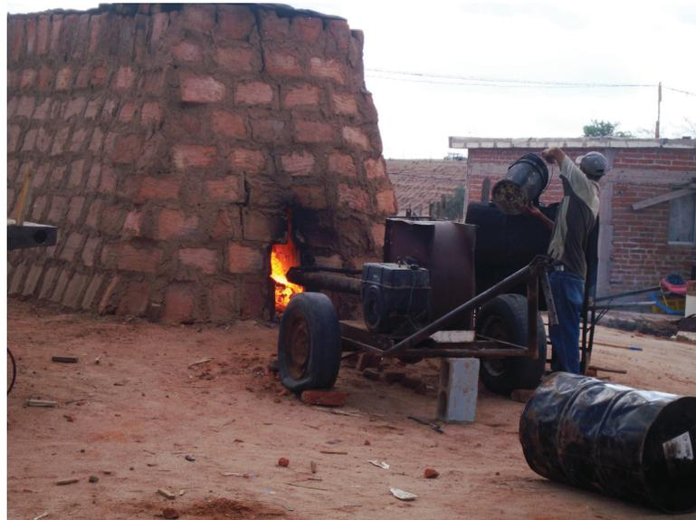
**Figura 6.** Fragua utilizada para obtener un flujo continuo del aceite usado en la cocción del ladrillo, Zona Ladrillera Sur.
