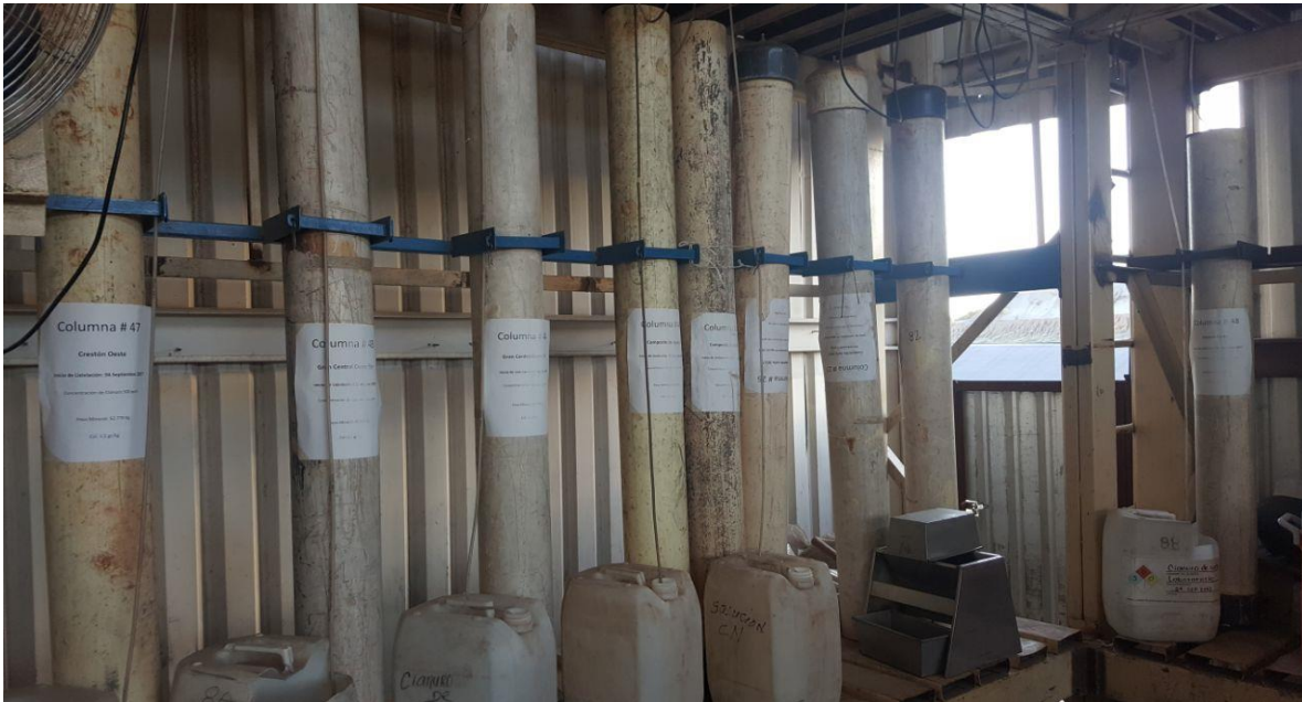
Figura 9. Pruebas de lixiviación en columnas.
