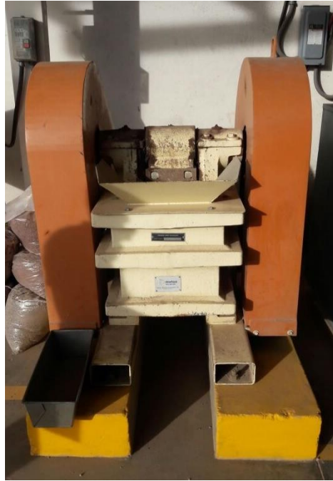
Figura 7. Quebradora utilizada para la preparación del mineral.
