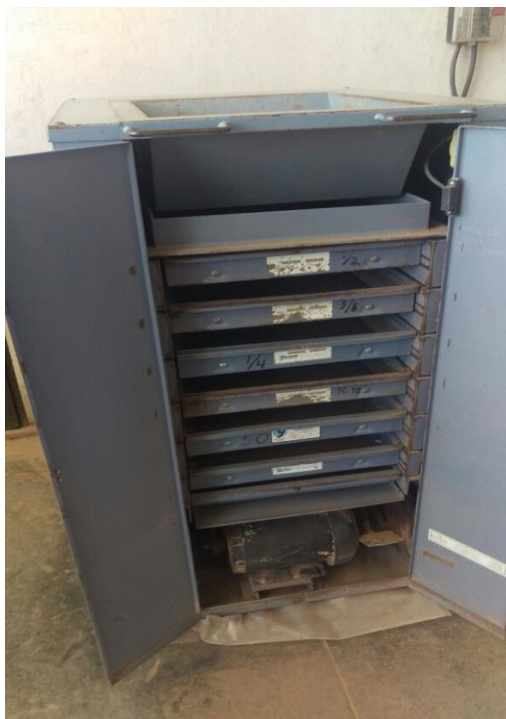
Figura 11. Criba Gilson utilizada para análisis granulométricos.
