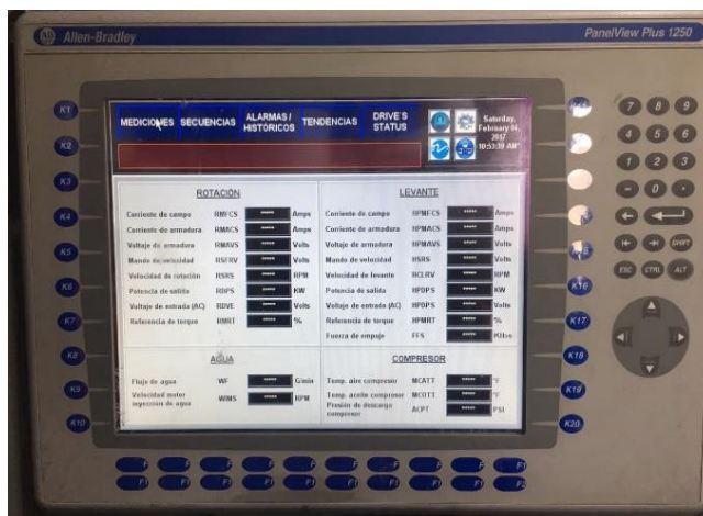
Figura 75. Aquí se puede observar que la visualización es más amigable con el operador y mostrando parámetros que antes no mostraba y que son importantes para el operador para realizar su trabajo.
