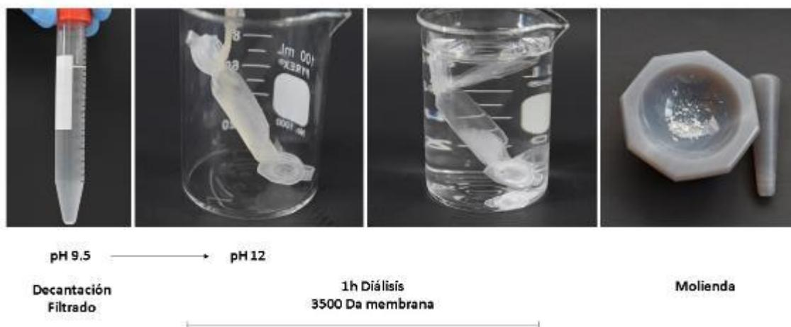
**Figura 13.** Proceso II de separación del bioconjugado de Ácido Oleico y L-Cisteína.
