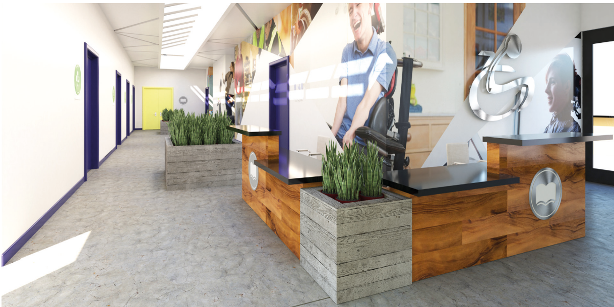
Ilustración 47. Vista interior de vestíbulo de edificio 1 (oficinas y consultorios). Se decidió emplear materiales aparentes en pisos (concreto pulido) por necesitar un bajo mantenimiento y porque logra una apariencia austera y elegante. Las puertas de oficinas y consultorios manejan colores sólidos, utilizando la paleta de colores de la Asociación Civil.
