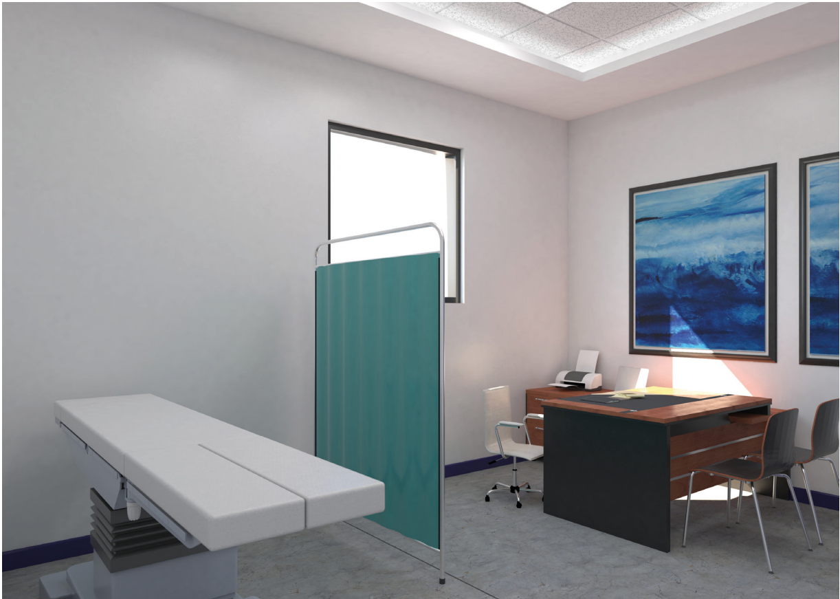
Ilustración 48. Vista interior a consultorio tipo. Para conseguir un mayor aprovechamiento en la iluminación natural y artificial se utilizó el color blanco en todos los muros. Los plafones en estas áreas están elaborados a base de plafones registrables y cajillos perimetrales de tablaroca.
