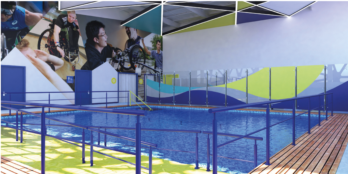
Ilustración 51. Vista interior de hidroterapia. Como en el caso del salón de mecanoterapia, el uso de plafones decorativos tiene un objetivo prioritario. La cubierta en esta área tiene una altura considerablemente mayor al resto de los espacios para evitar sofocamientos por humedad y temperaturas incómodas para los pacientes.
