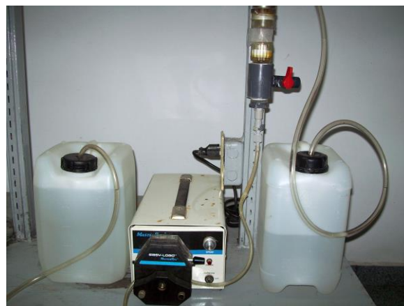
Figura 35. Parte inferior de la columna, mostrando el tanque de alimentación, la bomba y el tanque de descarga.
