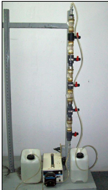
Figura 34. Columna dividida en cuatro secciones.
