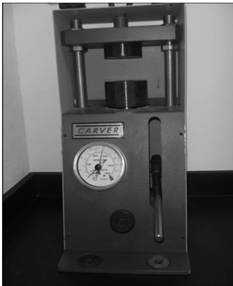
Figura 13. Prensa hidráulica utilizada para la fabricación de pastillas.
