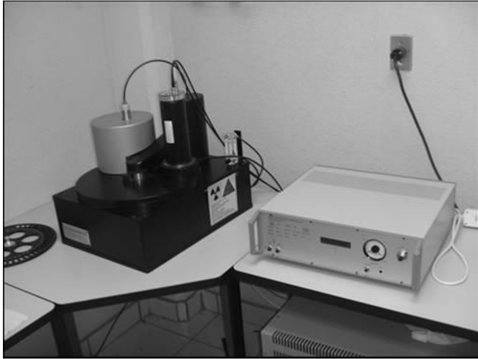
Figura 15. Equipo marca RISØ TL-DA-20 utilizado para la caracterización de TL y OSL.
