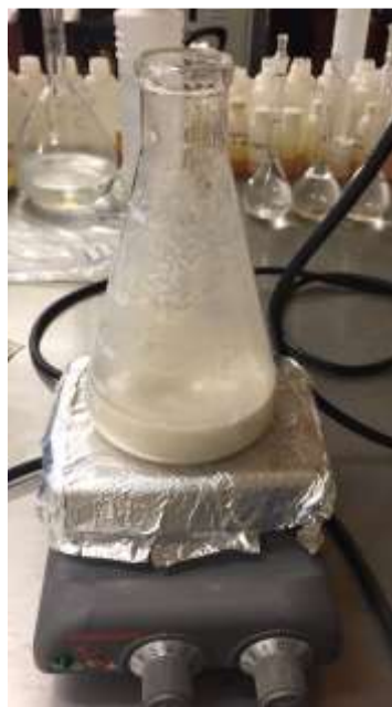
Figura 19. Reactor en donde se lleva a cabo la lixiviación.
