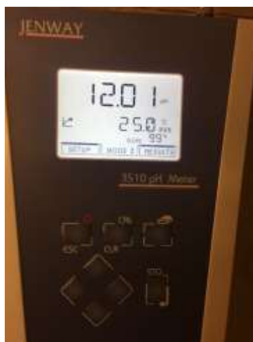
Figura 20. pH final obtenido después de 8 horas de lixiviación.
