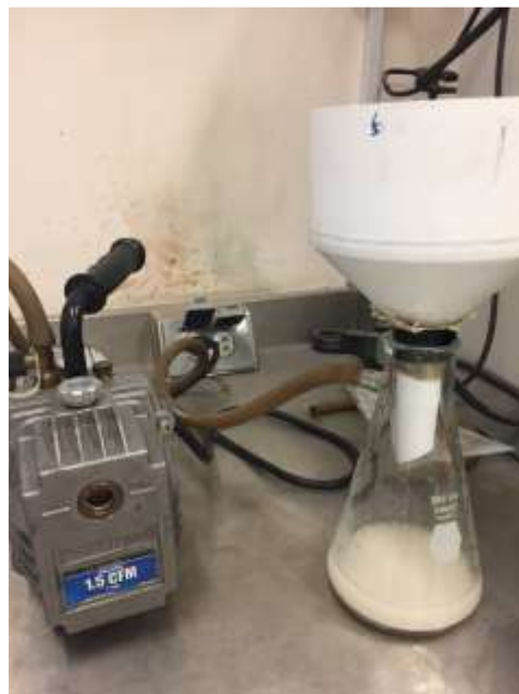
Figura 21. Filtración para la obtener la solución final.
