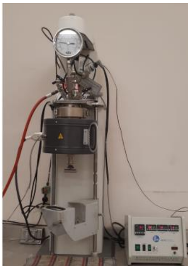
Figura 14. Reactor Parr de titanio con capacidad de 1 L.
