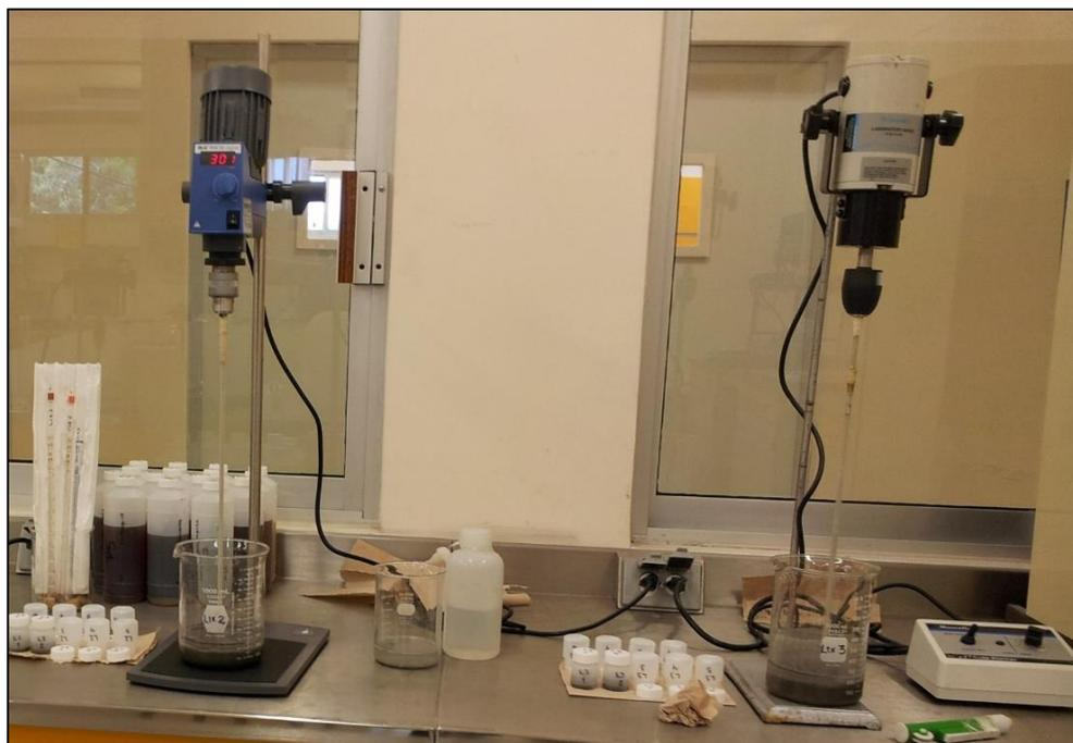
**Figura 16.** Sistema utilizado para la cianuración convencional en cada prueba
