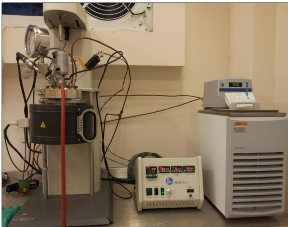
**Figura 17.** Autoclave (Parr, 1 L) utilizada en pruebas de cianuración a presión
