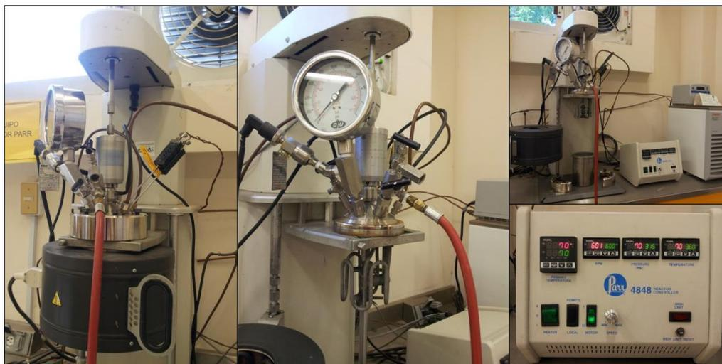
**Figura 10.** Autoclave Parr, utilizada en las pruebas de lixiviación con cianuro a presión
