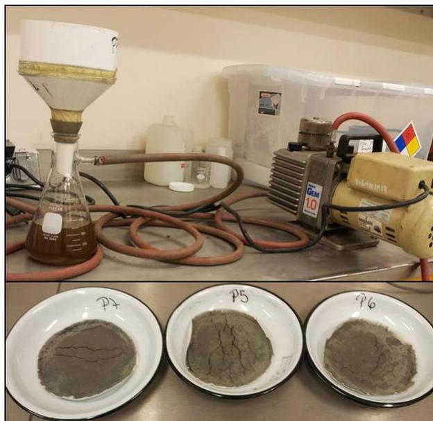
**Figura 12.** Sistema de filtración al vacío y producto obtenido, en cada prueba realizada
