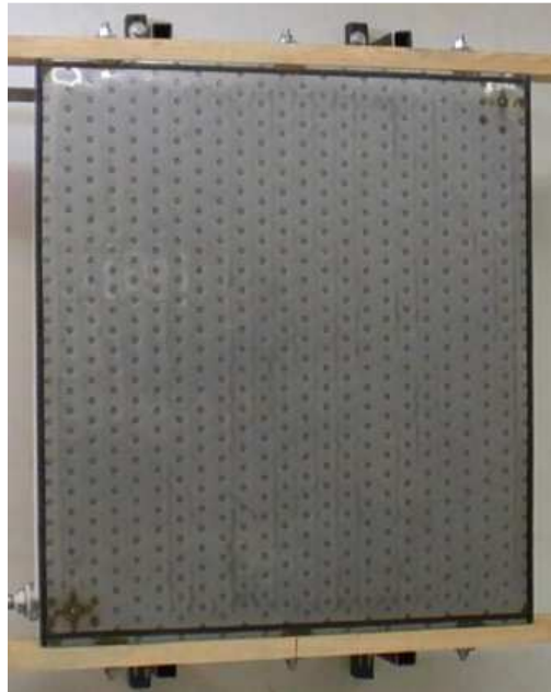
Figura 3.4 Intercambiador de calor.
