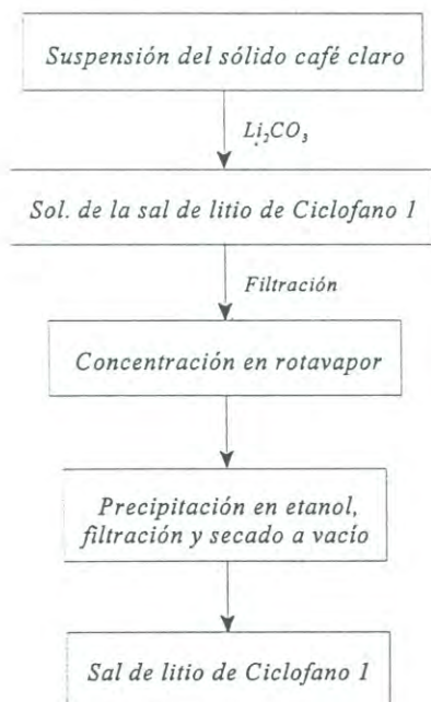
Figura 1.5 Diagrama de flujo para: (a) síntesis de Ciclofano 1, (b) formación de la sal de litio y (c) purificación de Ciclofano 1.
