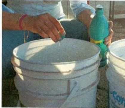
Figura 7. Adición de Hipoclorito de Sodio.
