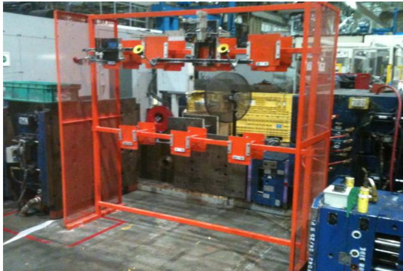
Figura 4.21. Árbol de brazo de robot mejorado.
