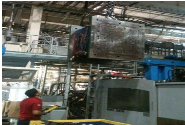
Figura 4.13. Centrado de molde.
