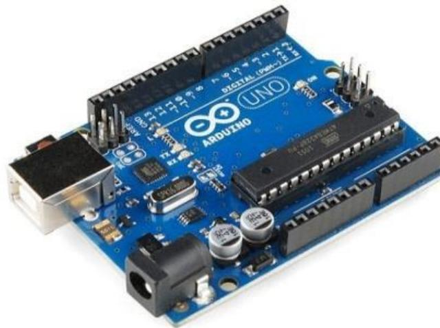
**Figura 4.4.** Placa de Arduino UNO.
