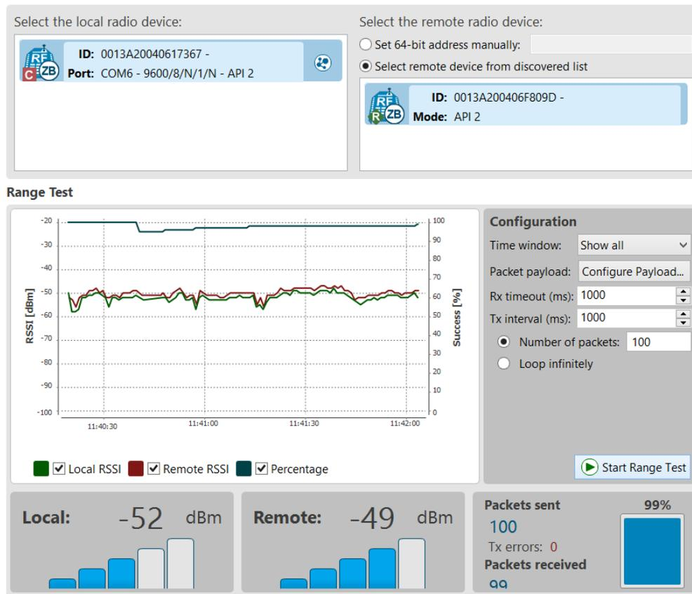
**Figura 4.11.** Mediciones en el software X-CTU.
