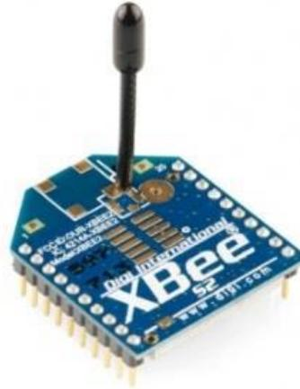
**Figura 4.5.** Módulo XBee S2.
